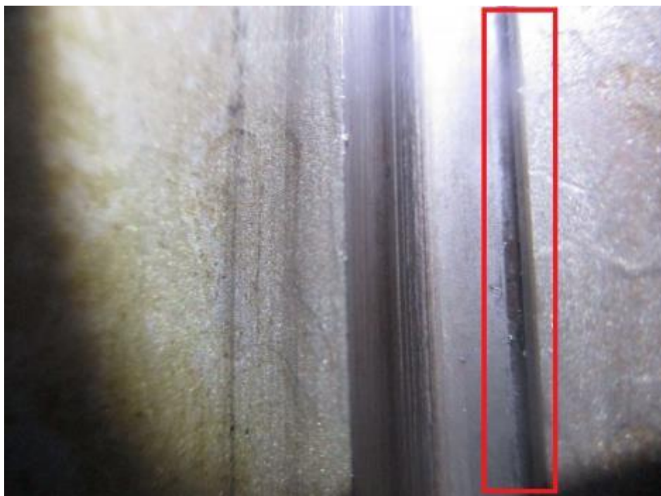
Slika 50. Provjera nakon prvog koraka tokarenja
