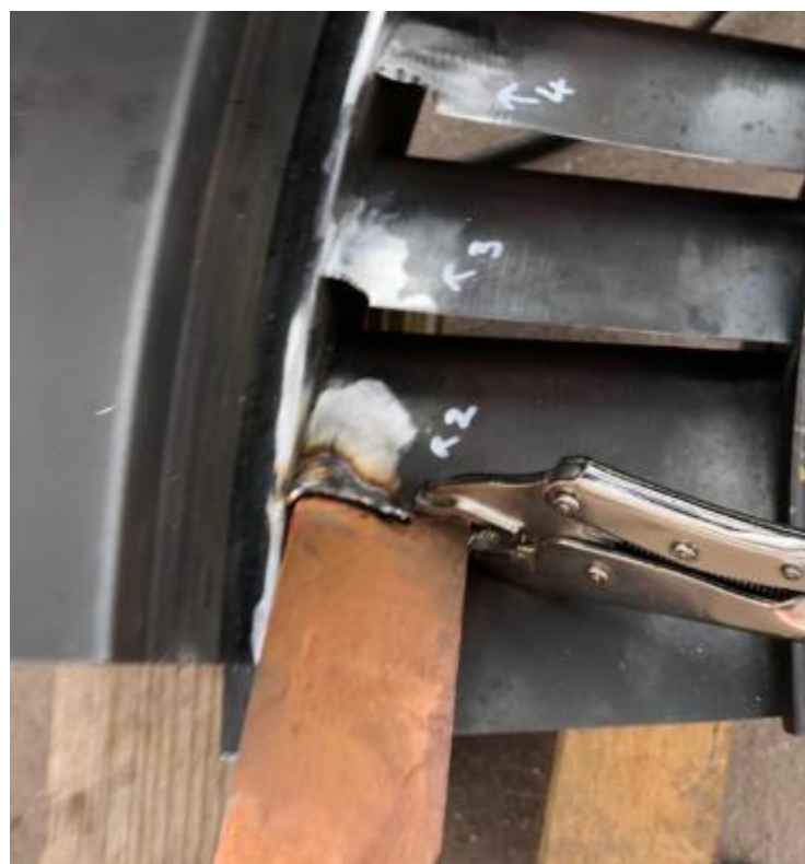
Slika 28. Početak navarivanja lopatice
