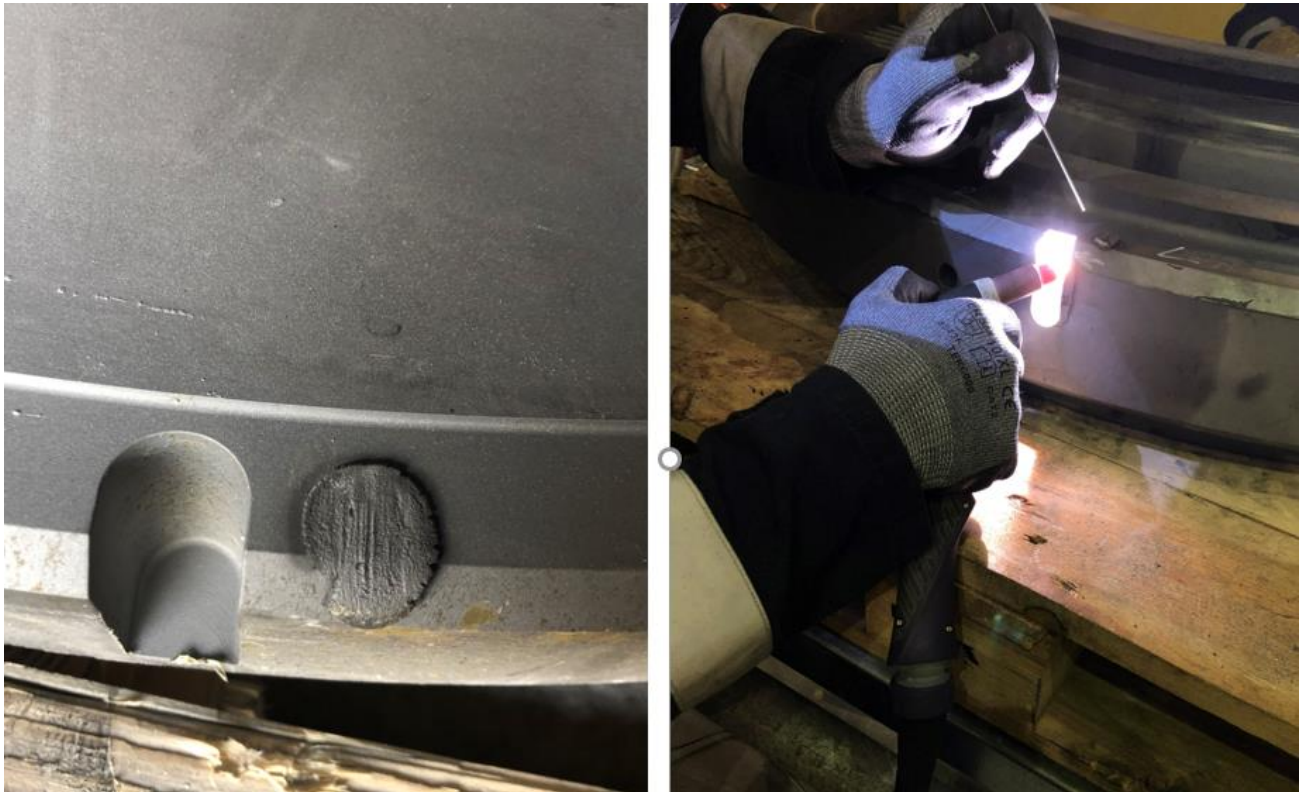
Slika 12. Navarivanje centralnog utora
