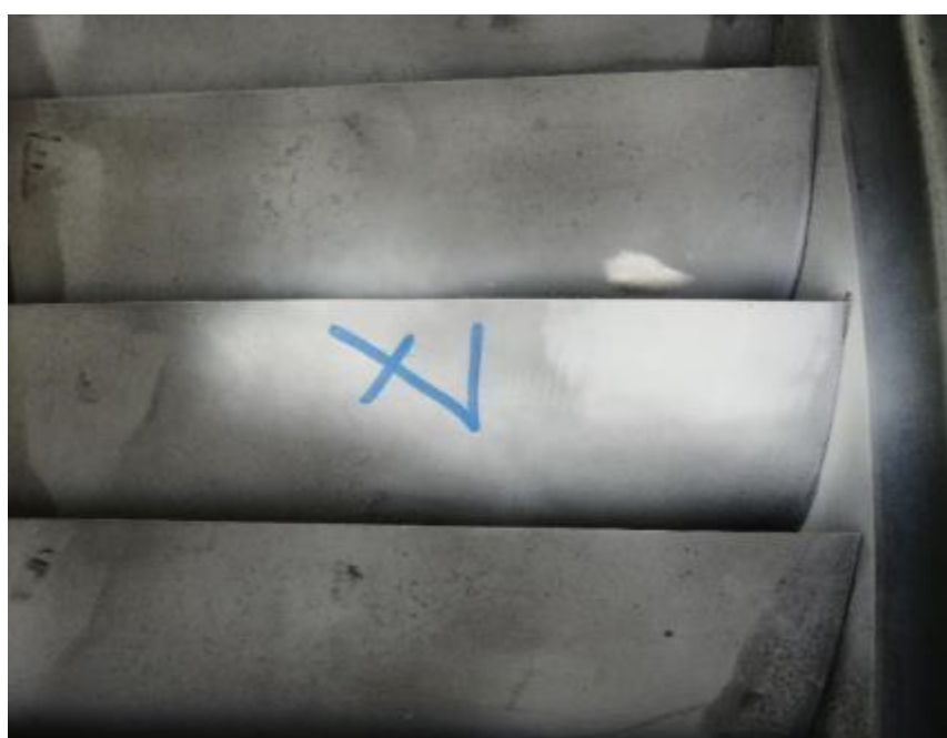
Slika 32. Završna provjera penetrantima nakon popravka
