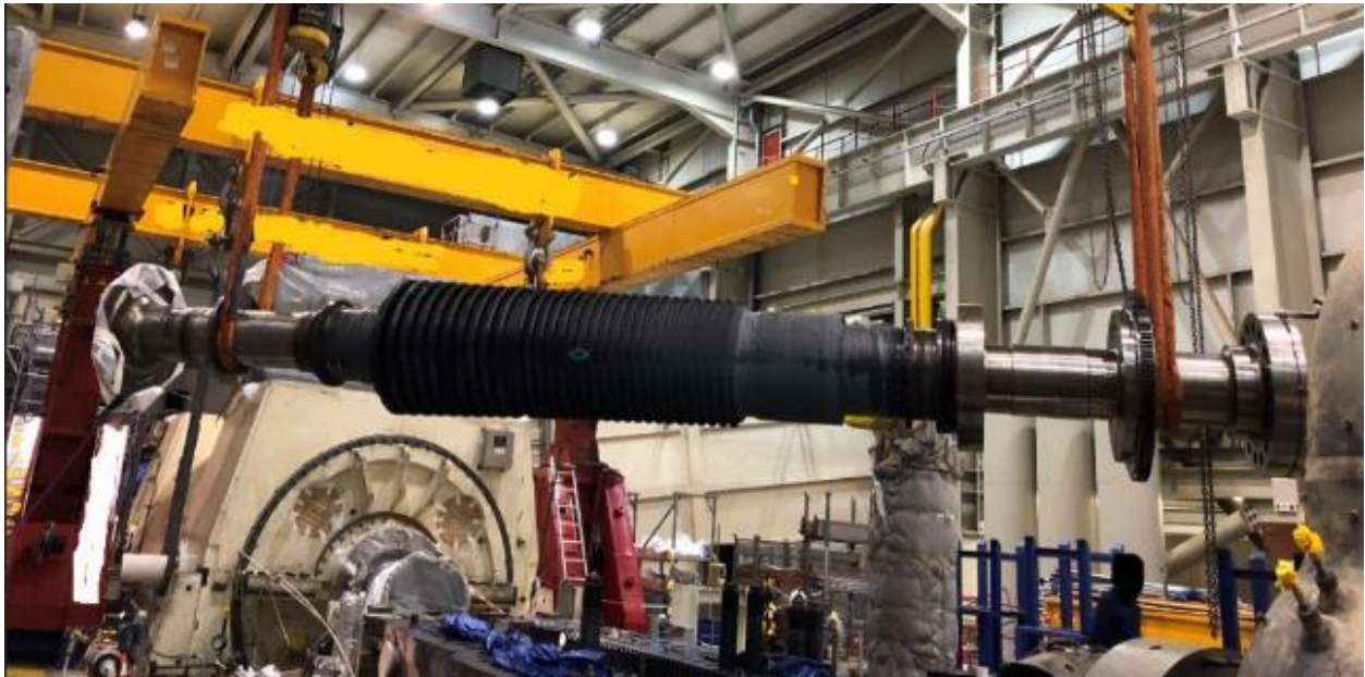
Slika 15. Rotor visokog tlaka
