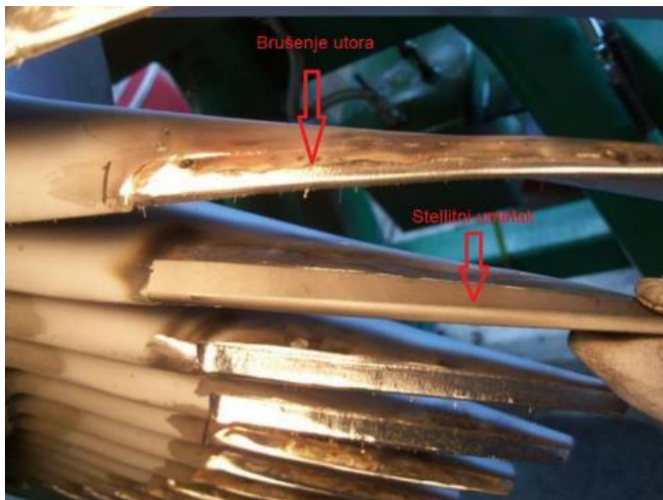
Slika 59. Priprema lopatica za lemljenje i zalemljeni umetak prije brušenja [3]
