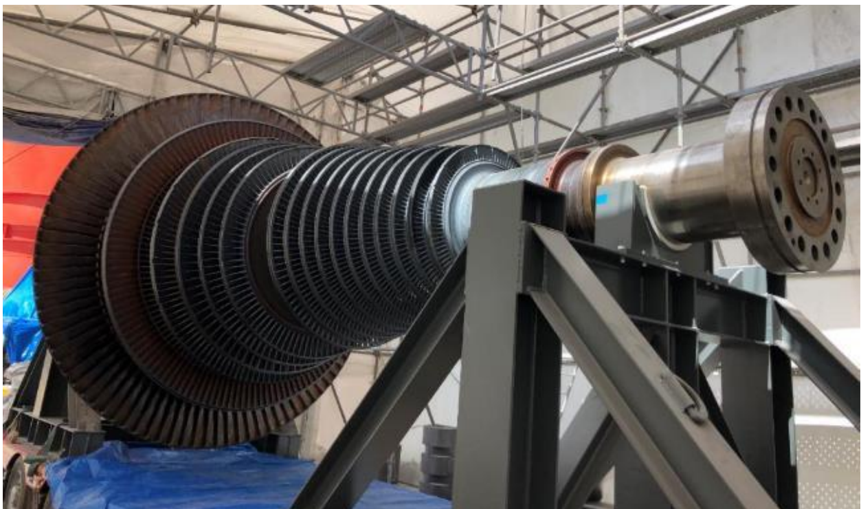
Slika 14. Rotor niskog i srednjeg tlaka
