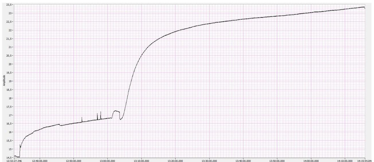
**Slika 10. Grafički prikaz temperature, mjerno mjesto T2 (mehanička brtva) [9]**
