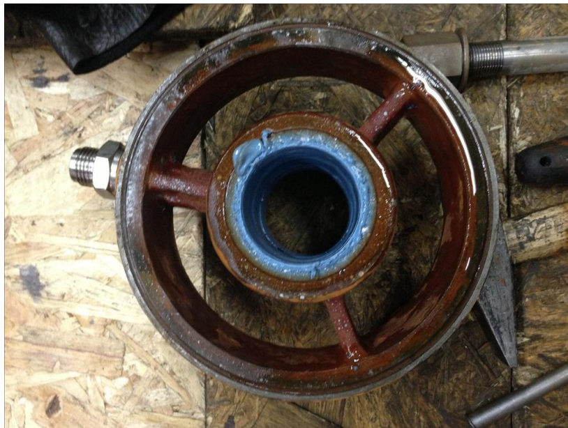
Slika 12. Rastaljeni klizni ležaj Thordon ThorPlas [9]
