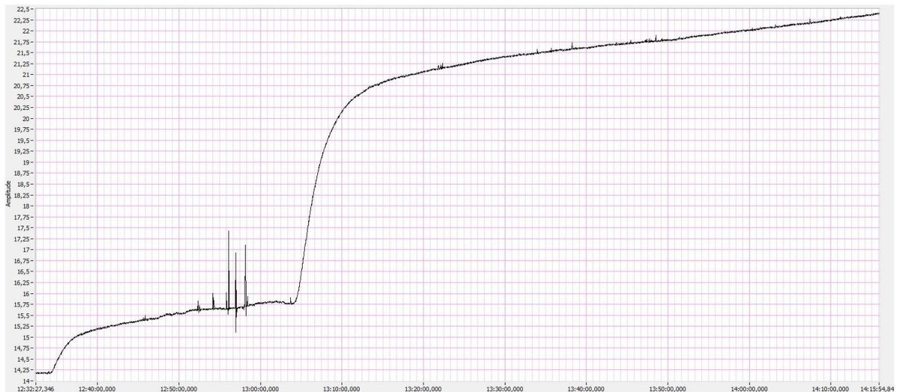
**Slika 9. Grafički prikaz temperature, mjerno mjesto T1 (klizni ležaj) [9]**
