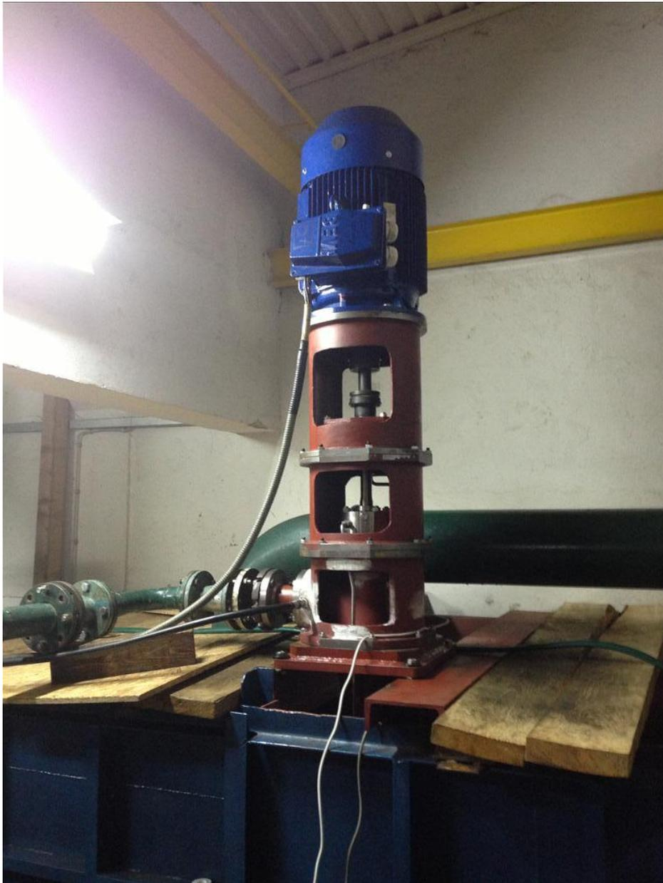
**Slika 4. Ispitivana pumpa na spremniku ispitne stanice [9]**
