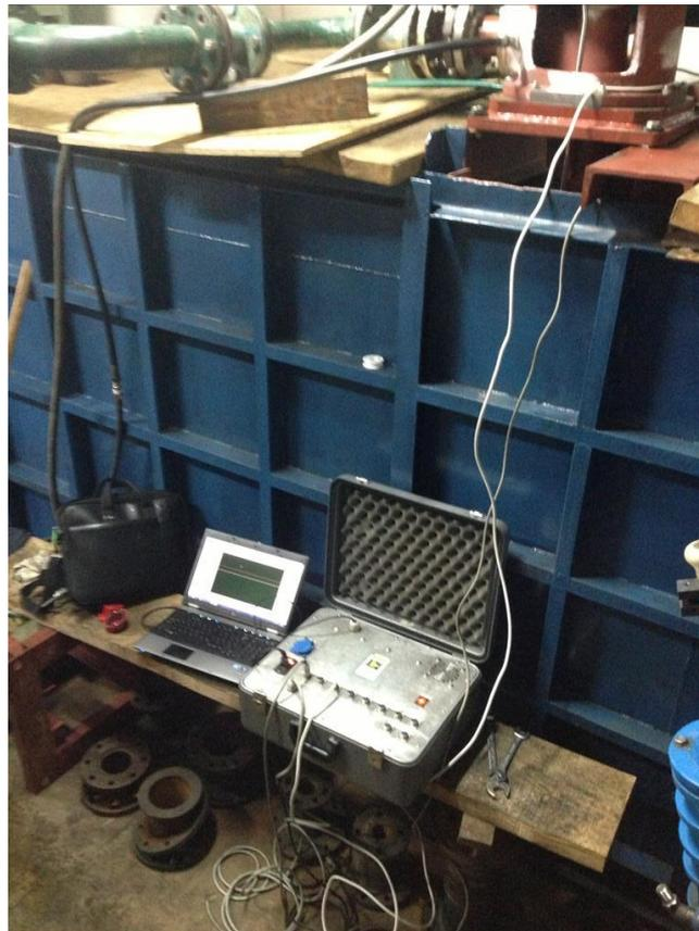
Slika 5. Mjerna opreme za vremensko praćenje temperature [9]
