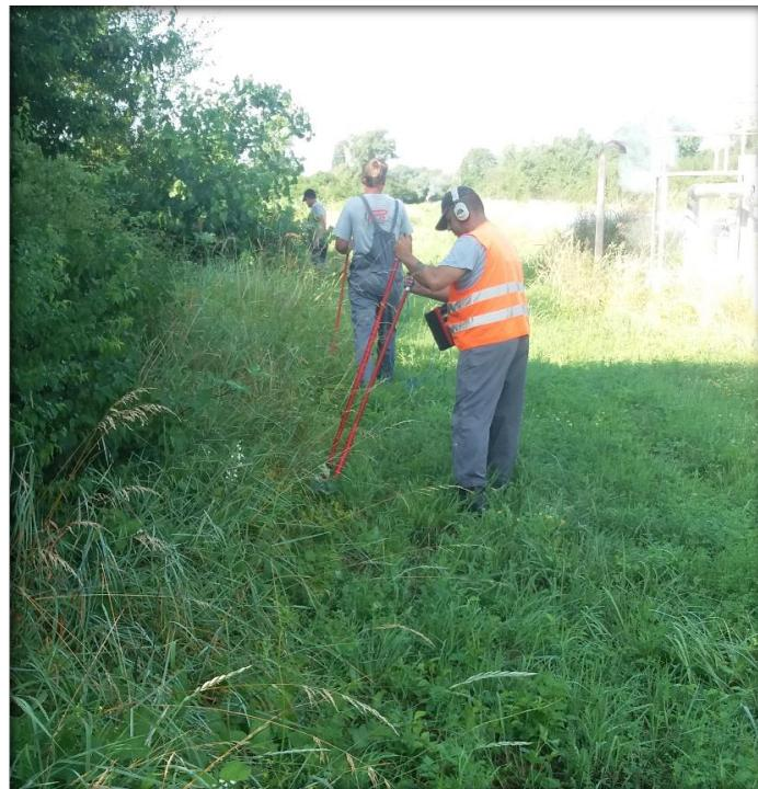
Slika 22. Prikaz mjerjenja oštećenja izolacije – Pearson metoda
