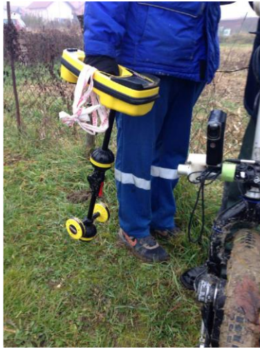
Slika 26. Lokator cjevovoda – proizvođača RIGID
