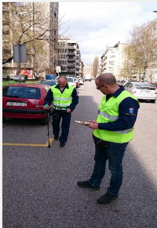
Slika 13. Prikaz ispitivanja nepropusnosti plinske mreže
