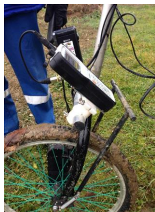
Slika 27. Nosač instrumenta i video kamere
