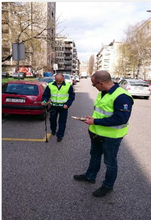
Slika 13. Prikaz ispitivanja nepropusnosti plinske mreže
