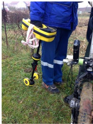
Slika 26. Lokator cjevovoda – proizvođača RIGID
