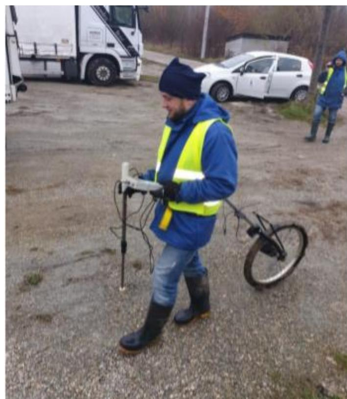
Slika 33. Magnetometrijsko snimanje VT plinovoda
