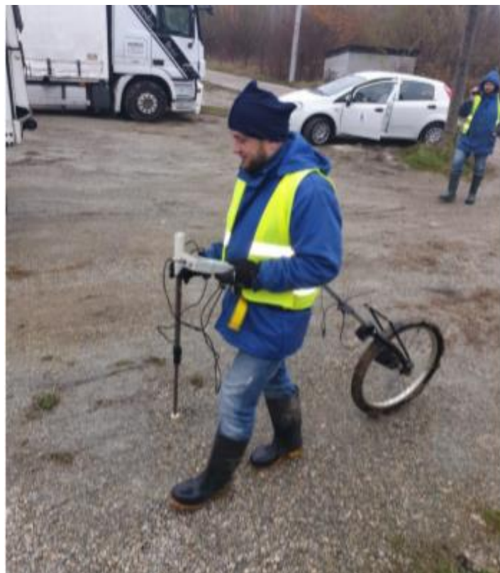
Slika 33. Magnetometrijsko snimanje VT plinovoda
