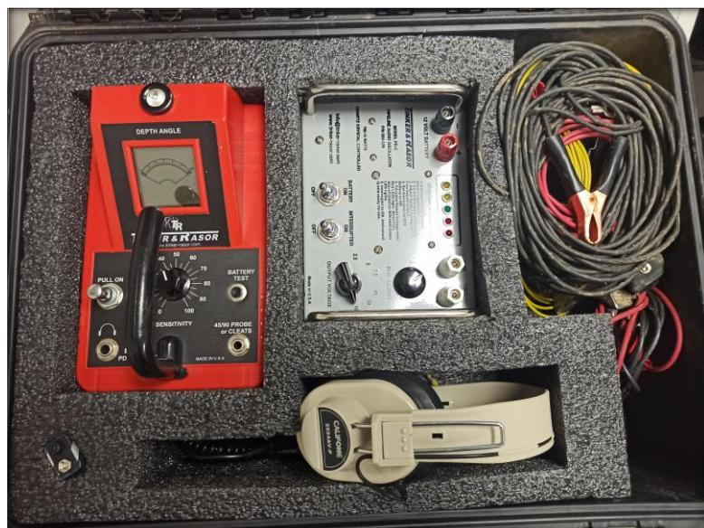
Slika 21. Uređaj za mjerjenje oštećenja izolacije –MK-IV
