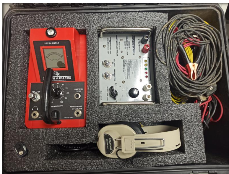
Slika 21. Uređaj za mjerenje oštećenja izolacije –MK-IV
