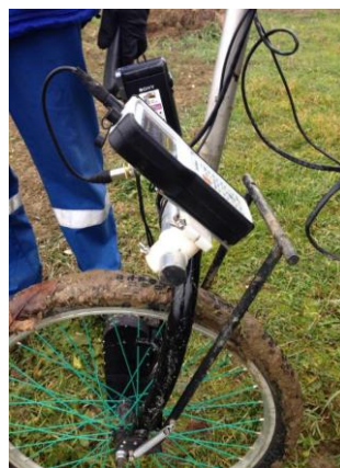
Slika 27. Nosač instrumenta i video kamere
