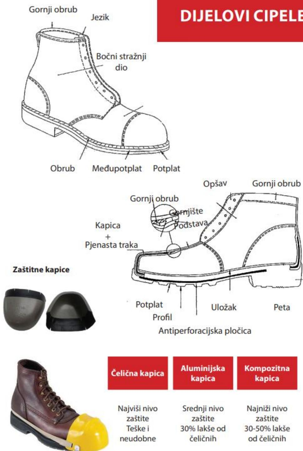
Slika 23. Dijelovi zaštitne cipele <sup>8</sup>
