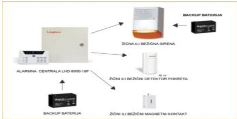
**Slika 1:** Shema spajanja žične alarmne centrale i elementi žičnog protuprovalnog sustava
