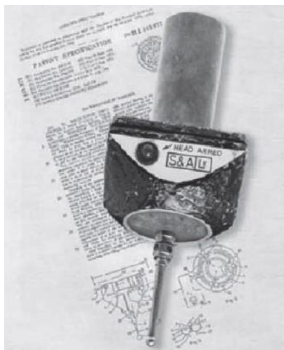
Slika 14. Prvo dodirno mjerno ticalo koje je izumio Sir David McMurtry 1972. godine [10]
