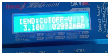
Slika 50. Vrijeme pražnjenja i vrijednost izmjenog kapaciteta drugog uzorka
