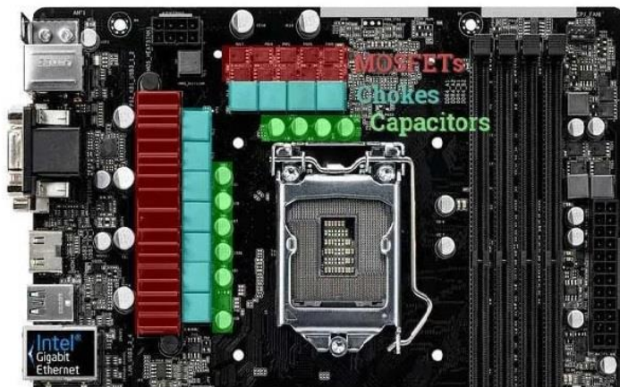
Slika 37. Raspored VRM-a kod matične ploče osobnog računala (eng. Choke = hrv. zavojnica) [48]
