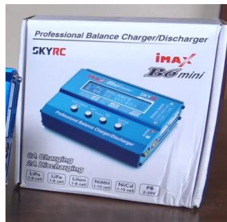
Slika 47. Imax B6 mini, balansni punjač do 6 članaka u seriji
