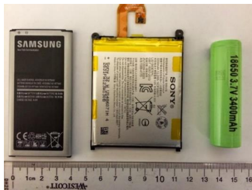
Slika 10. Dva najčešća fizička formata litij ion baterije
