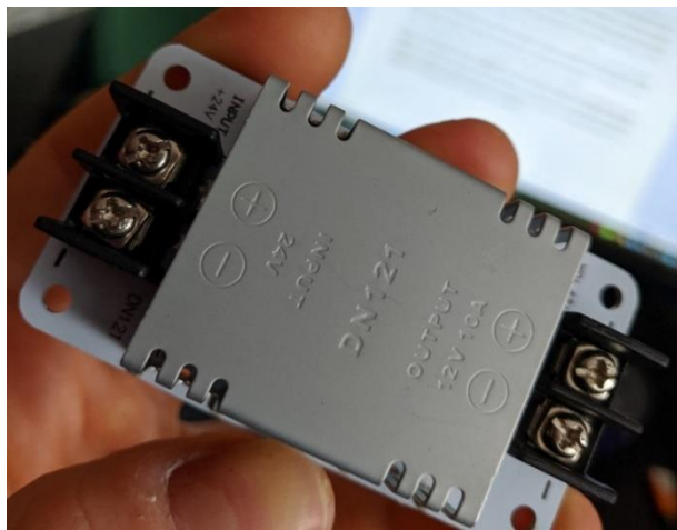
Slika 38. Izgled „DN121“ DC-DC silaznog naponskog regulatora
