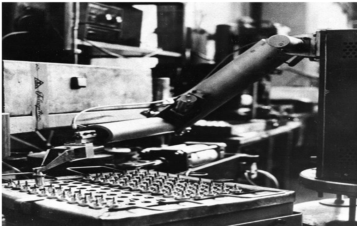
Slika 4. Unimatov prvi robot . [10]
