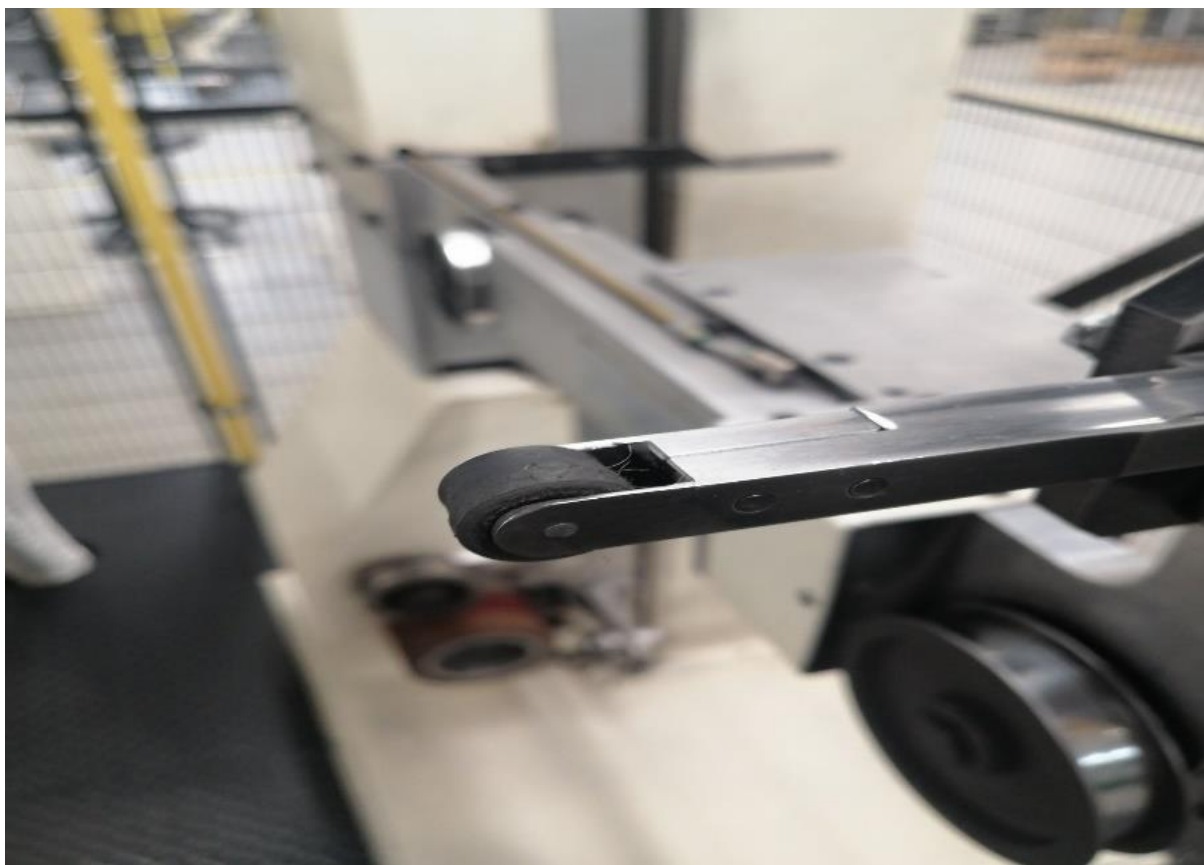
Slika 28. Prikaz istrošenog vulkaniziranog kotačića nakon skidanja brusne trake
