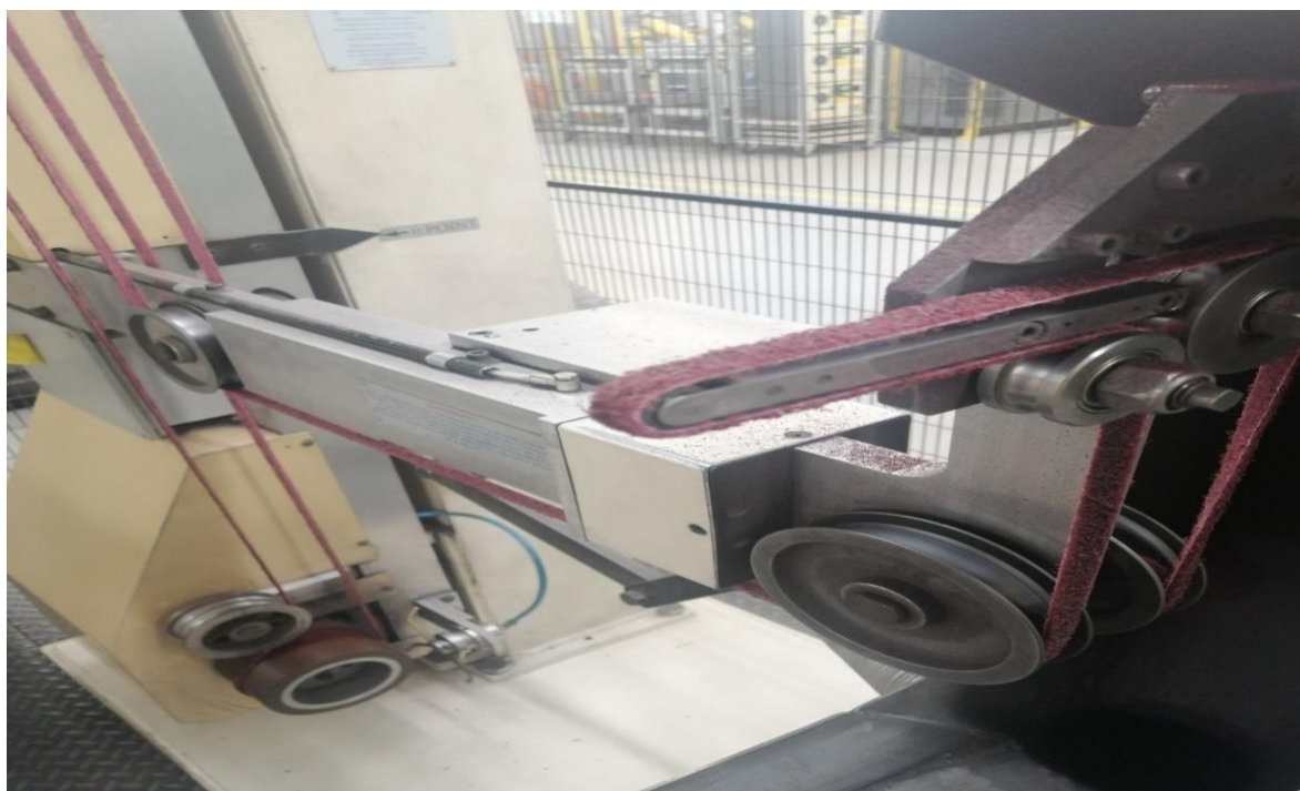
Slika 27. Prikaz istrošene brusne trake sa vulkaniziranim kotačićem
