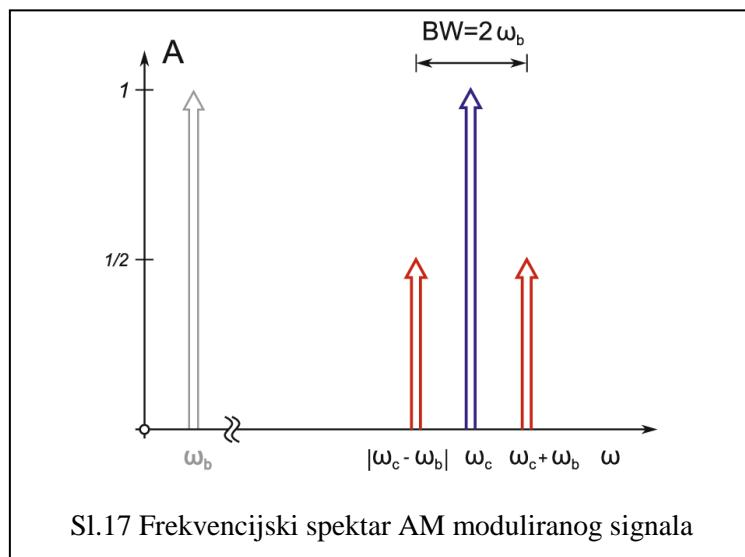
Potrebno je naglasiti da se amplitude gornjeg i donjeg harmonika množe sa  $\frac{m}{2}$ , što u najboljem slučaju kada je  $m = 1$  znači da je amplituda tih harmonika polovica amplitude nosećeg signala. Također, za signal čiji je najviši harmonik neka frekvencija  $\omega_b$ , amplitudno moduliran signal zauzima bandwidth  $BW = 2\omega_b$  koji je centriran oko noseće frekvencije.
