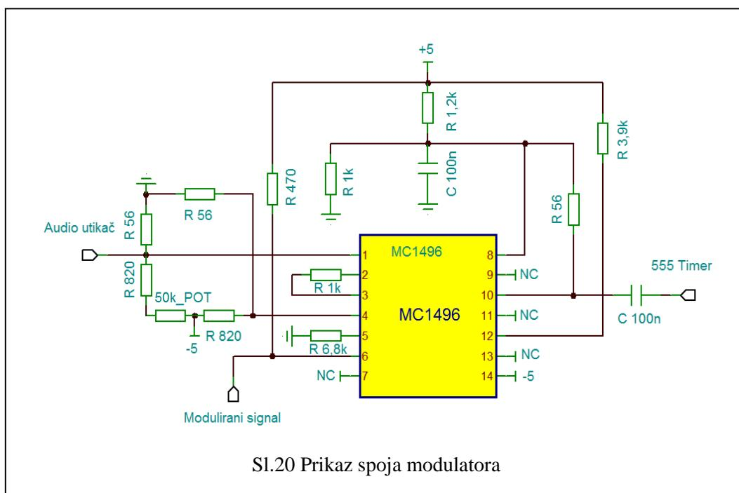
Postoji više načina modulacije: amplitudna, frekvencijska i fazna modulacija od kojih svaka ima svoje prednosti i mane. Od ove tri navedene, amplitudna modulacija (AM modulacija) koja je detaljnije opisana ranije u poglavljju 3.3.1 Amplitudna modulacija, biti će korištena. Razlog je
