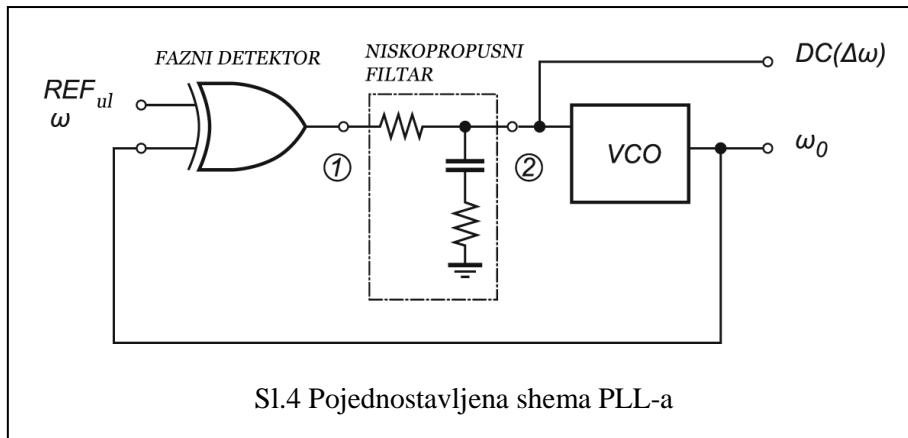
U svom najosnovnijem obliku, PLL sadrži tri glavna elementa : fazni detektor, niskopropusni RC filter i VCO povezane u povratnu vezu.
