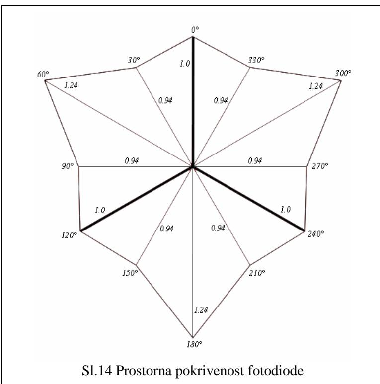
Ako se tri IR diode rasporede na međusobni razmak od  $120^\circ$ , moguće je pokriti cijeli prostor od  $360^\circ$  tako da veličina  $S_E$  nikada ne padne ispod vrijednosti 0.90 bez obzira na kut  $\varphi_1$ , što je prikazano na Sl.13. Ako se ista stvar napravi sa tri fotodiode, veličina  $S_R$  nikada ne padne ispod 0.94 bez obzira na kut  $\varphi_2$ , što je prikazano na Sl.14.
