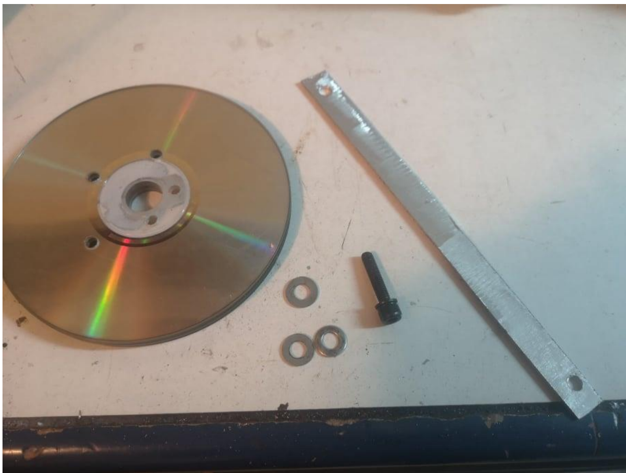
Slika 41. Klipnjača sa dijelovima za spoj sa radnim kolom
