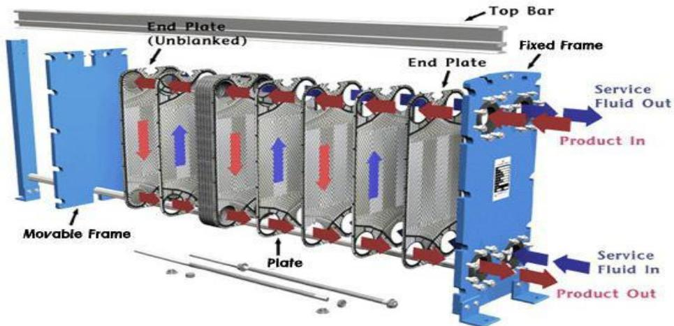
Slika 7 Pločasti izmjenjivač topline ([www.foodprocessinghub.pbf.hr](http://www.foodprocessinghub.pbf.hr))
