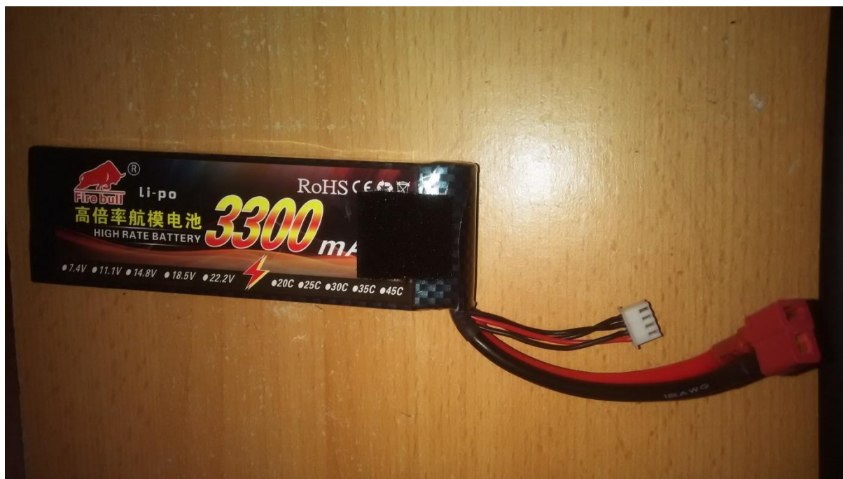
Slika 16. Fire Bull 3S 3300 mAh 25C baterija
