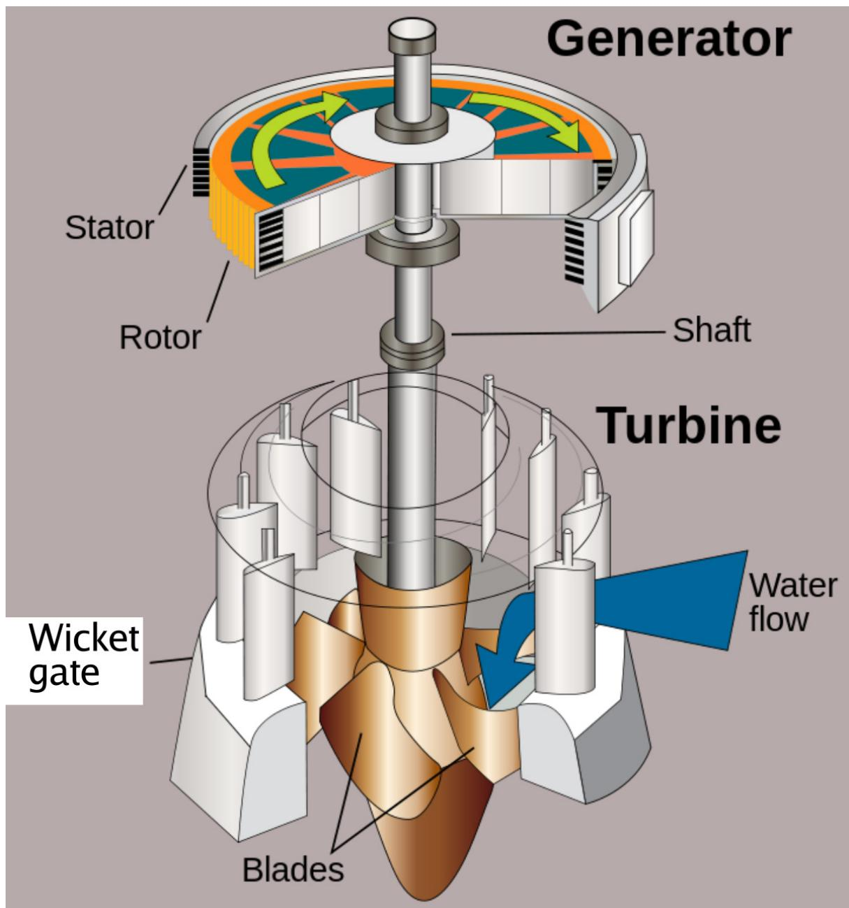
**Slika 2.2.1** Princip rada i djelovi hidroturbine. [2]
