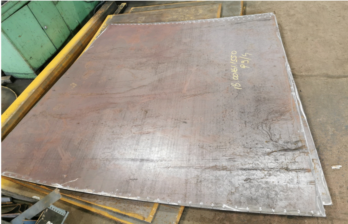
Slika 10.2 Ocrtane linije savijanja p.9/4.
