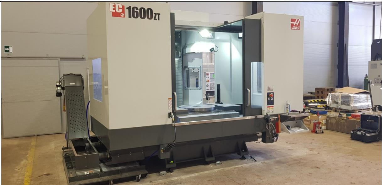
**Slika 5.6** Horizontalni obradni centar HAAS EC 1600 ZT.
