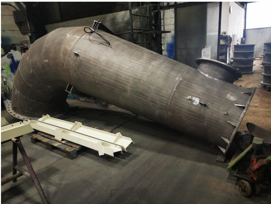
Slika 14.4 Pjeskarena pozicija na pripremi za ličenje.
