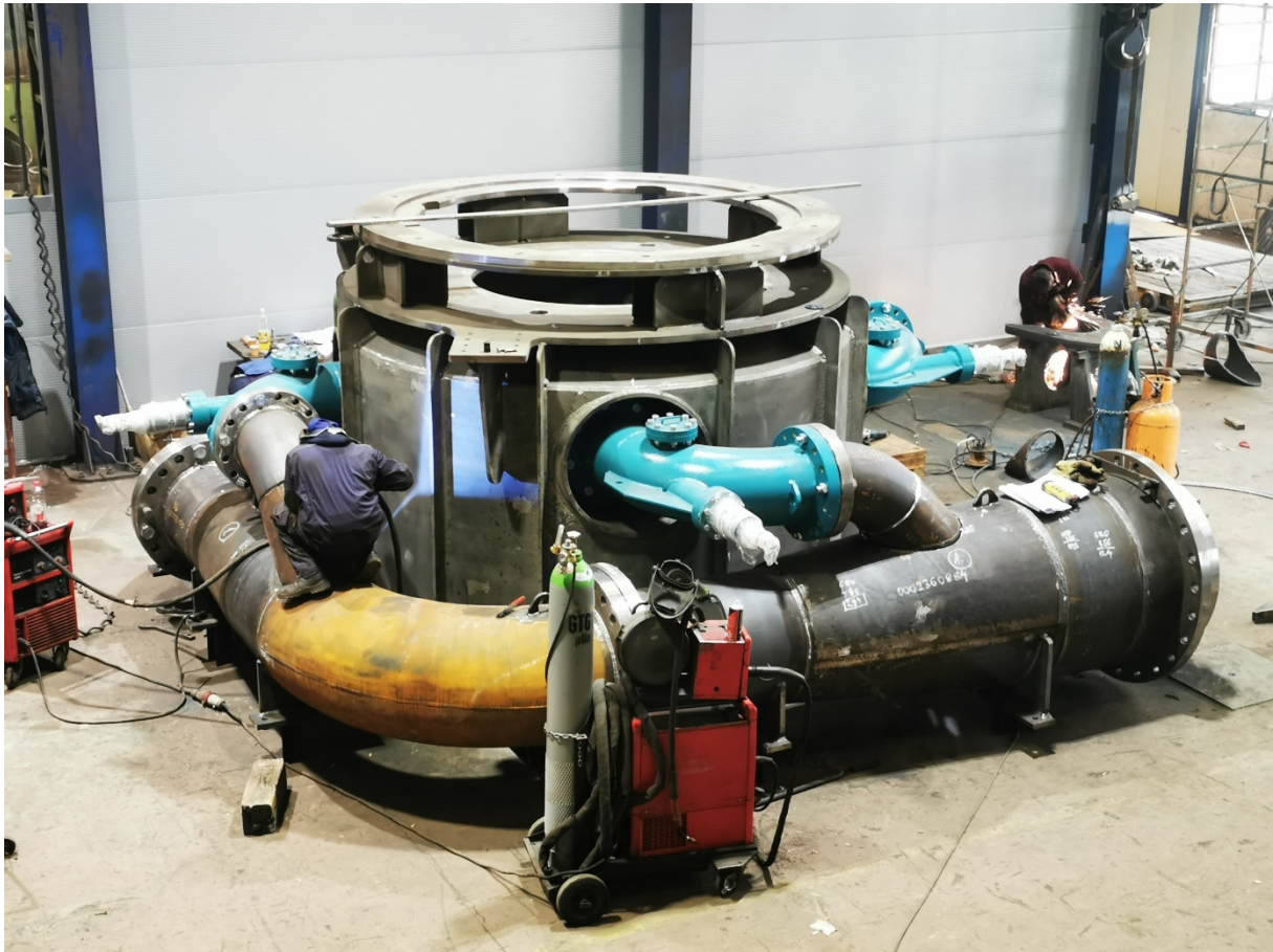
Slika 2.3.2 Kućište pelton turbine sa cjevovodom proizvedeno u AB Produktu.
