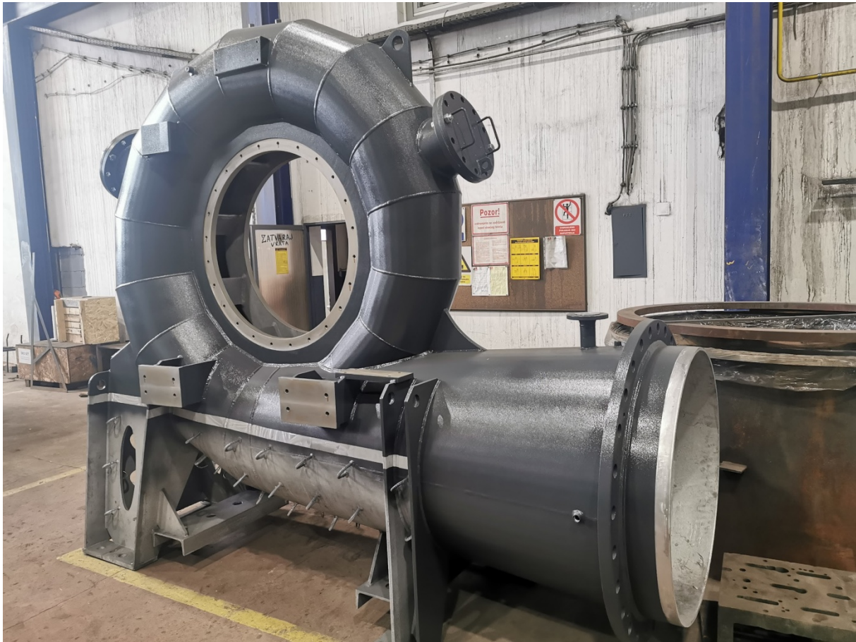
Slika 2.3.3 Spiralno kućište francis turbine proizvedeno u AB Produktu.
