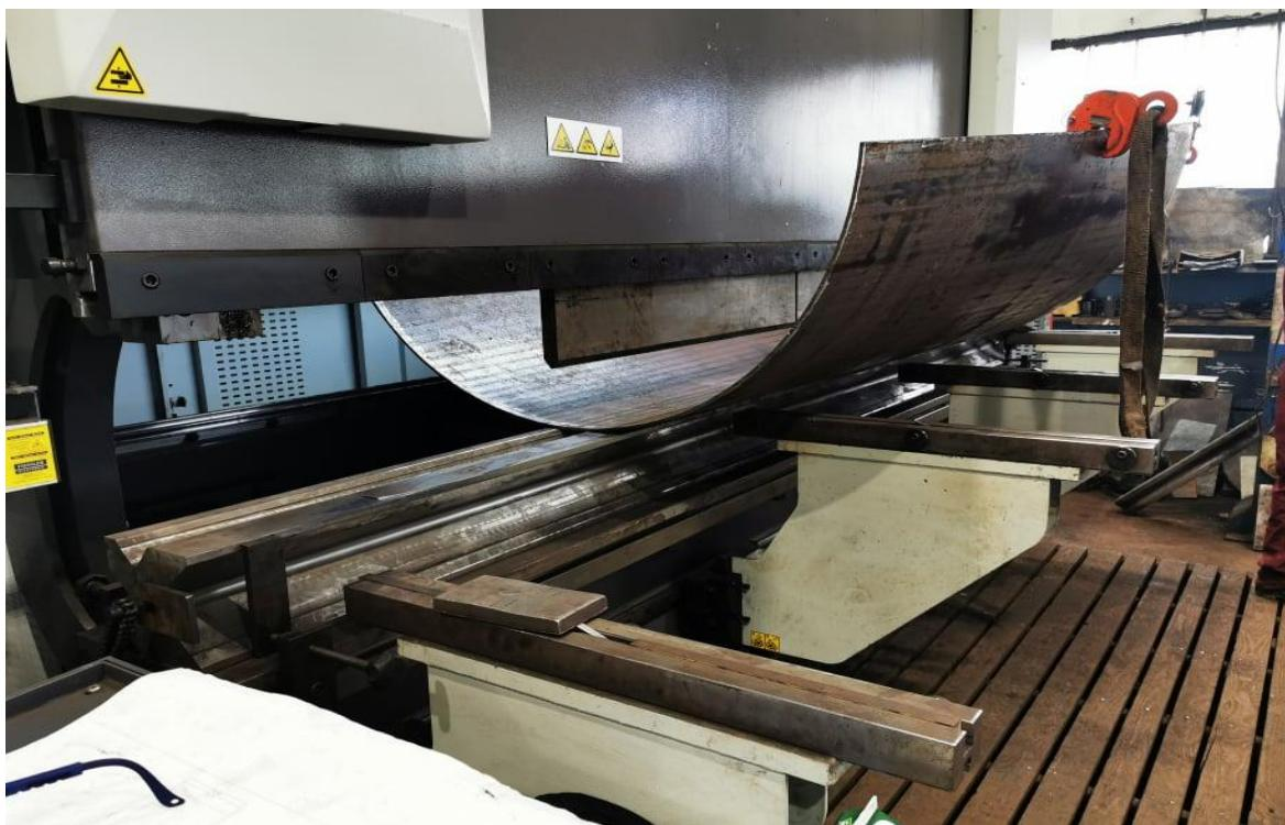
**Slika 10.3** Savijanje na apkant preši p.9/4.
