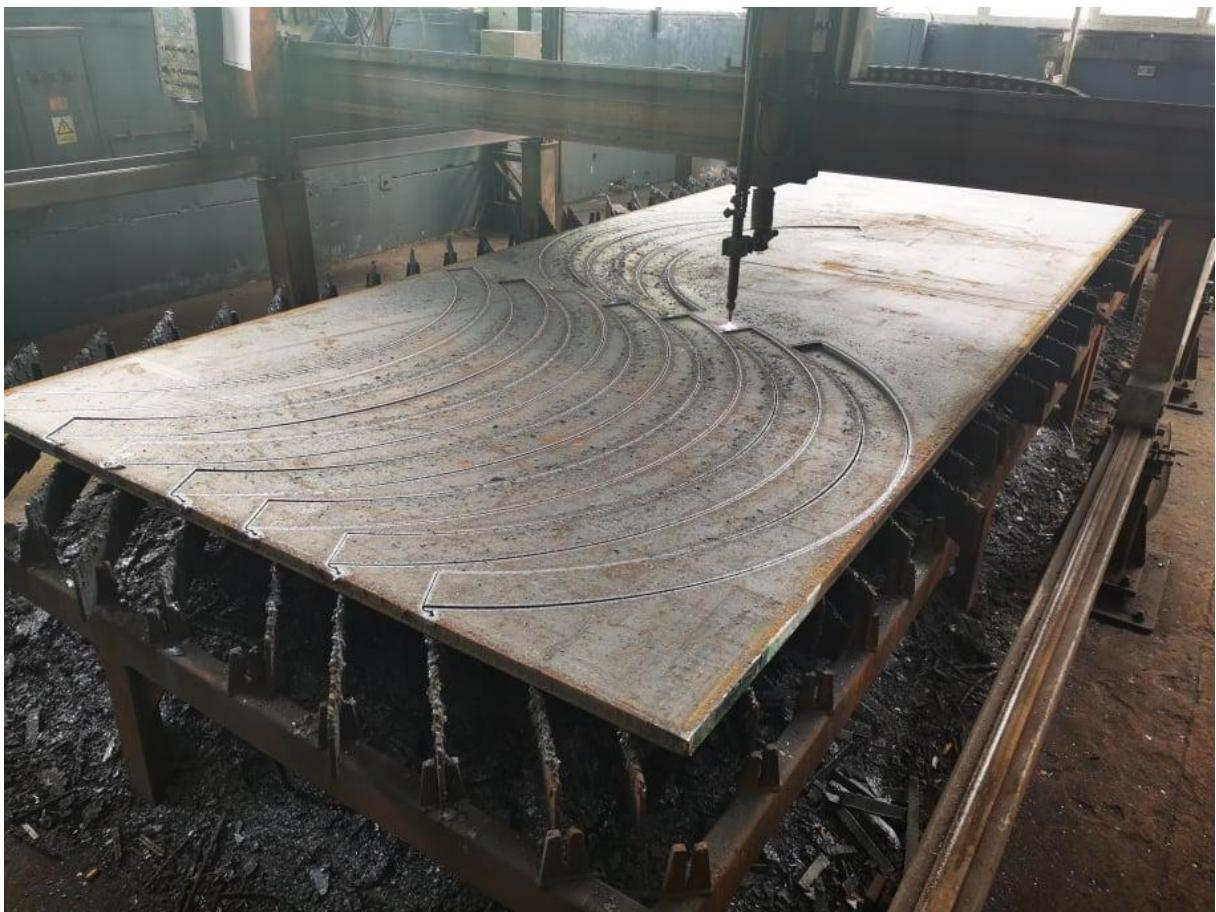
Slika 5.1 CNC plinska rezalica Varstroj.
