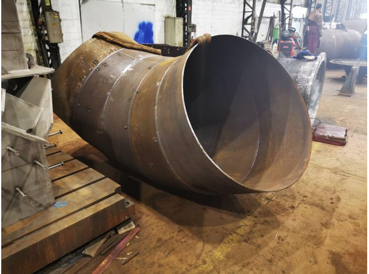
Slika 14.1 Savinute i bravarski složene pozicije 2 (5kom).
