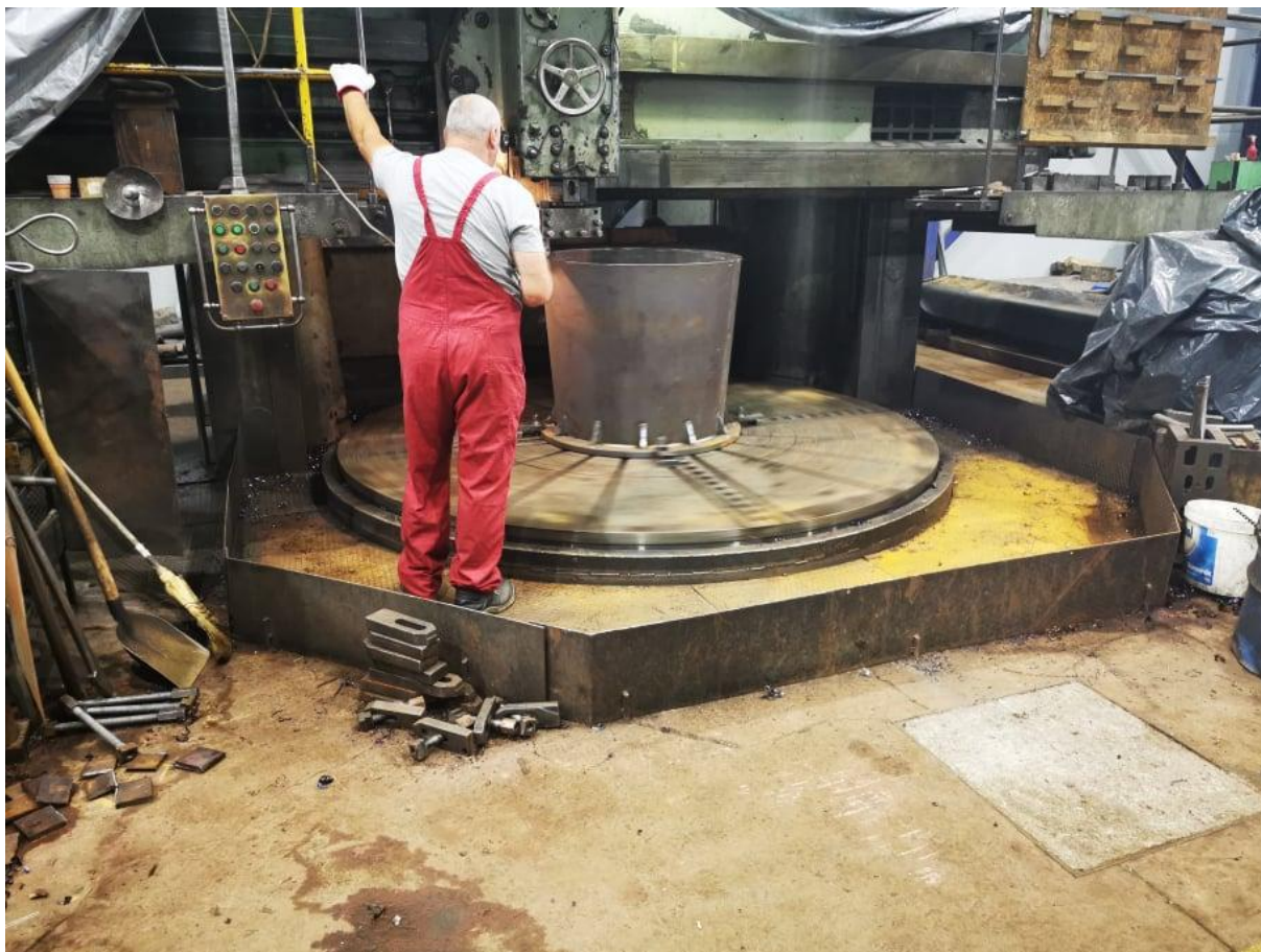
Slika 11.2 Predobrada prirubnice p.3 na vertikalnoj tokarilici RAFAMET KCF-320.
