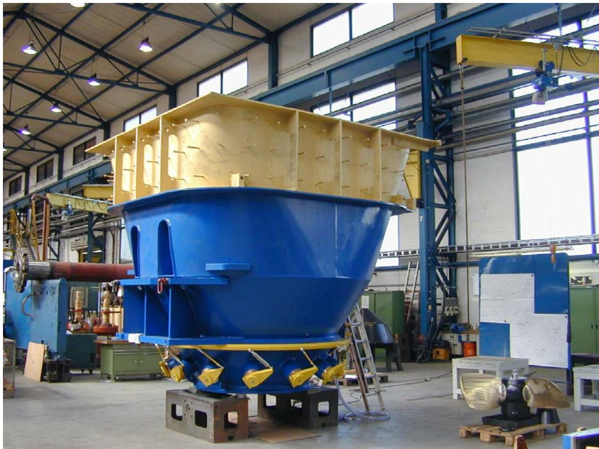
**Slika 2.3.4** Kućište kaplan turbine proizvedeno u AB Produktu.
