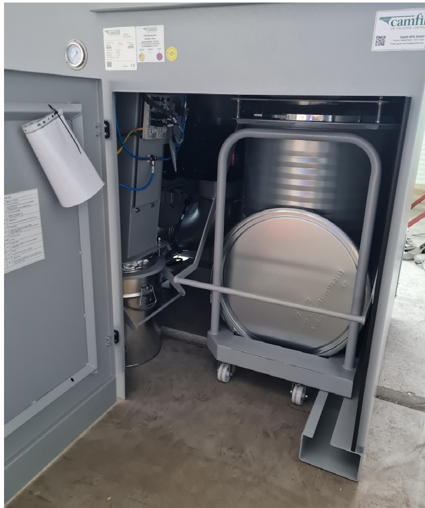
Slika 13. Kompaktni otprašivač sa kantom za pohranu prašine
