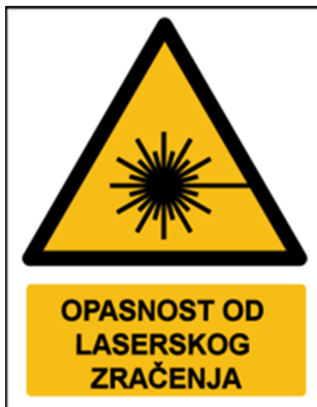
Slika 16: oznaka opasnosti laserske zrake [6]
