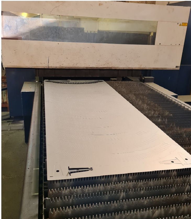
Slika 7. Radni stol sa obrađenim materijalom
