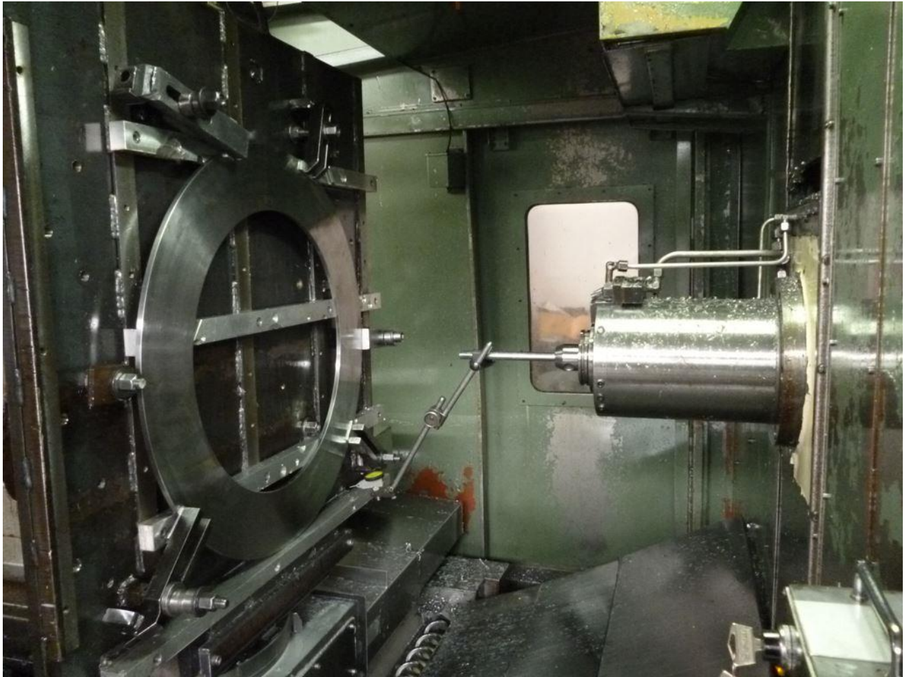
Slika 16. Horizontalni obradni centar H-15, centriranje komada
