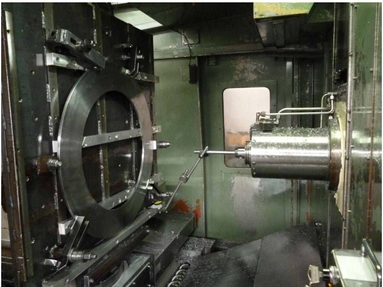
*Slika 16.* Horizontalni obradni centar H-15, centriranje komada
