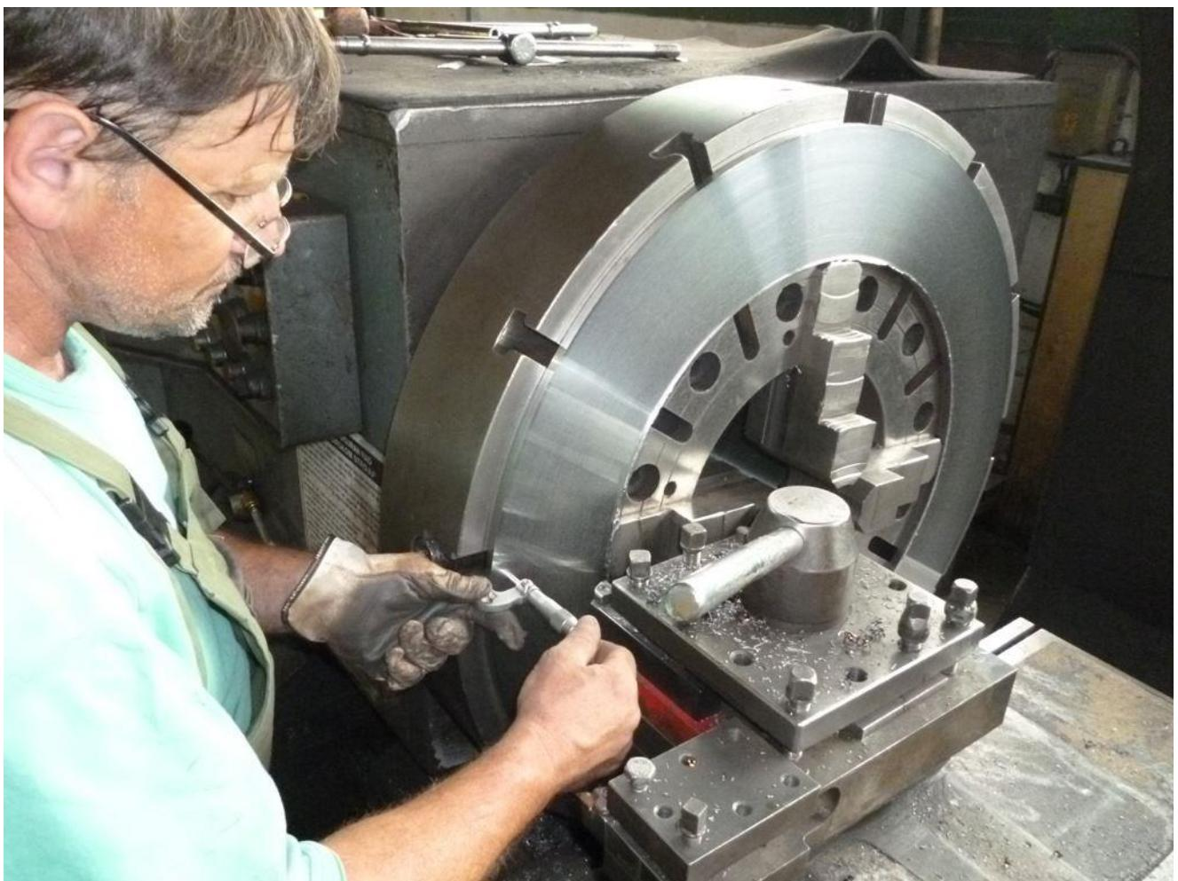
*Slika 15. Obrada tokarenjem na zadanu debljinu*
