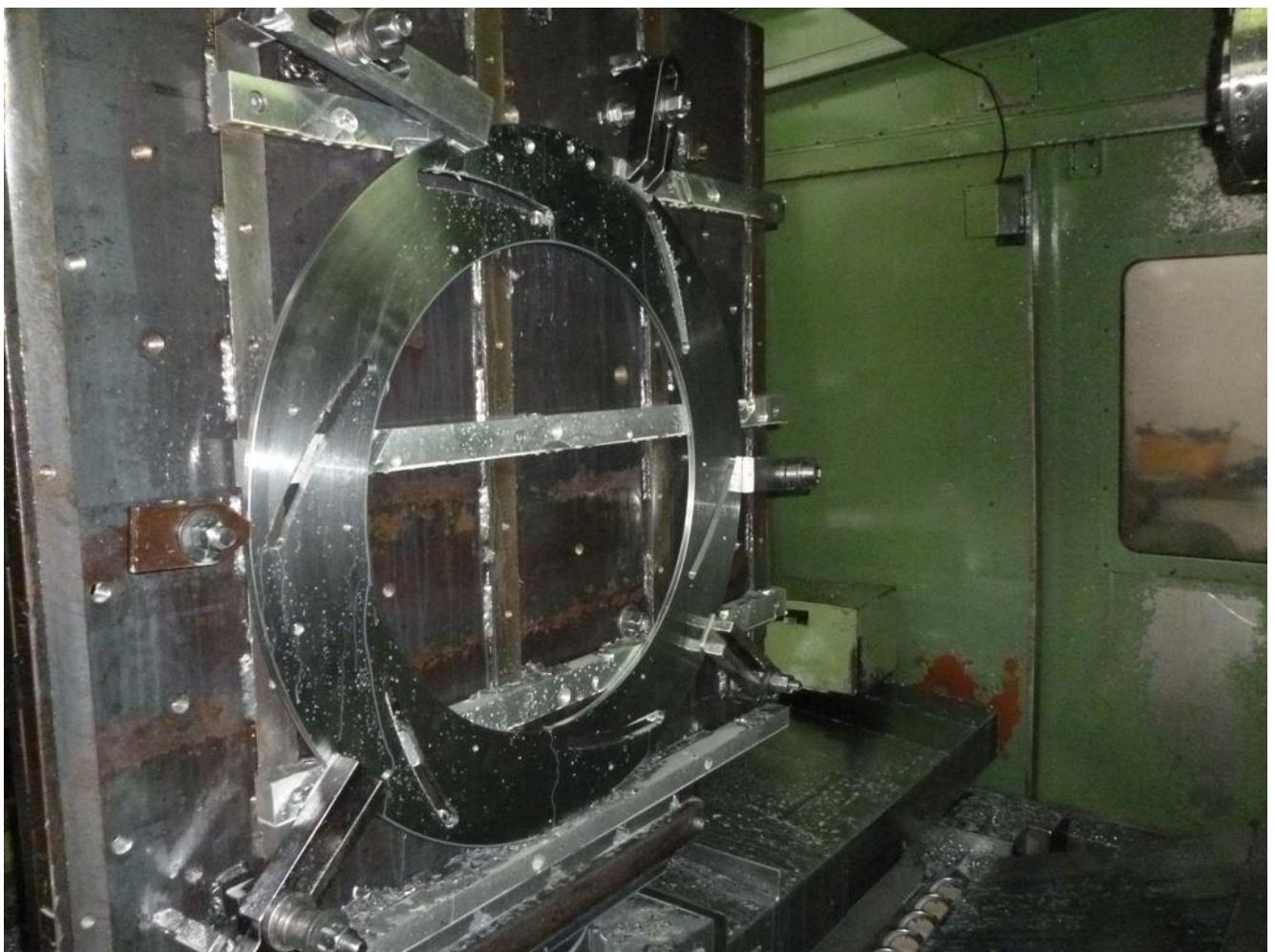
*Slika 17.* Obrada bušenja prorvta, urezivanja navrta i glodanja utora
