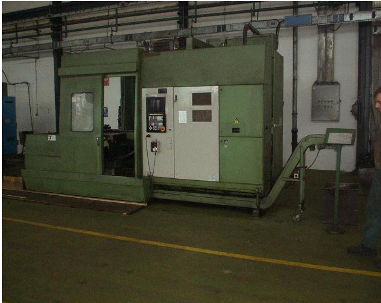
*Slika 11. Horizontalni obradni centar H15- MB*
