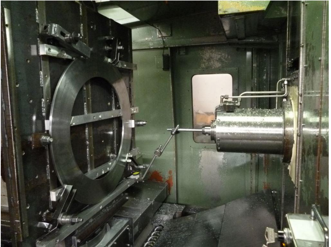
Slika 16. Horizontalni obradni centar H-15, centriranje komada
