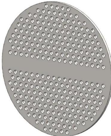
Slika 34 Cijevna ploča izmjenjivača
