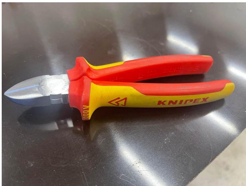
Slika 8. Izolirana kliješta za sječenje 1000V [Vlastiti izvor]
