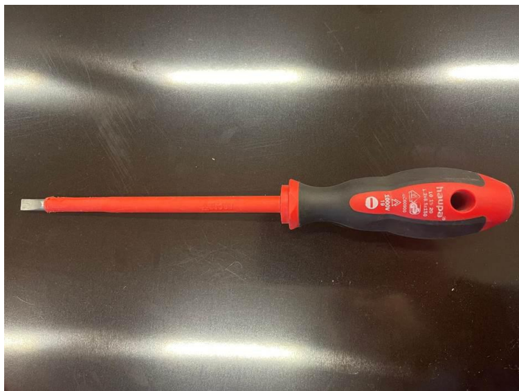
Slika 7. Izolirani odvijač 1000V [Vlastiti izvor]
