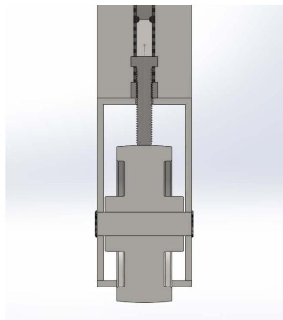
**Slika 15 Presjek blokade kotača**
