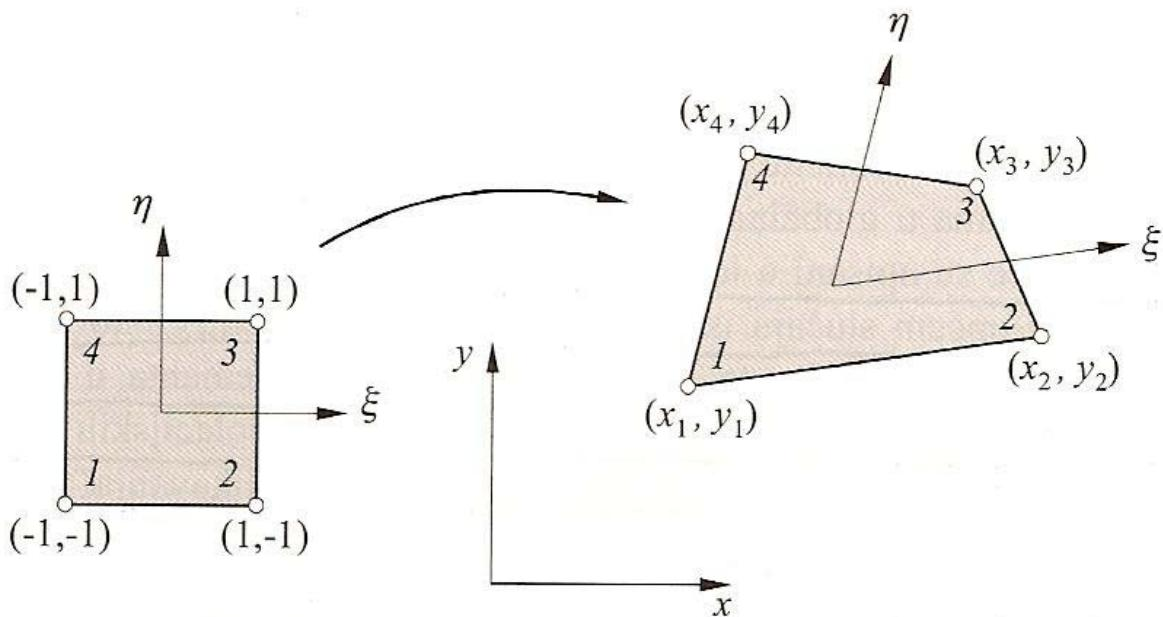
Slika 4 Preslikavanje izvornog elementa u proizvoljni četverokutni
