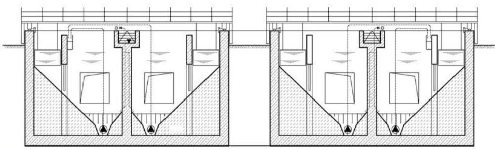
**Slika 9.** Poprečni presjek kroz pjeskolov – mastolov
