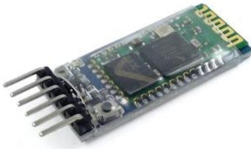
Slika 9 : HC-05 modul na pločici [9]
