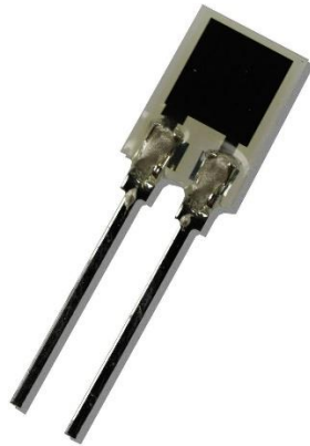
Slika 28. Prikaz kapacitivnog senzora vlažnosti. Izvor [20].
