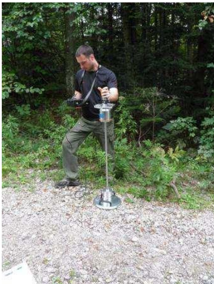
Slika 7. Provedba mjerenja nosivosti šumske ceste (Branišelj, S. 2013)
