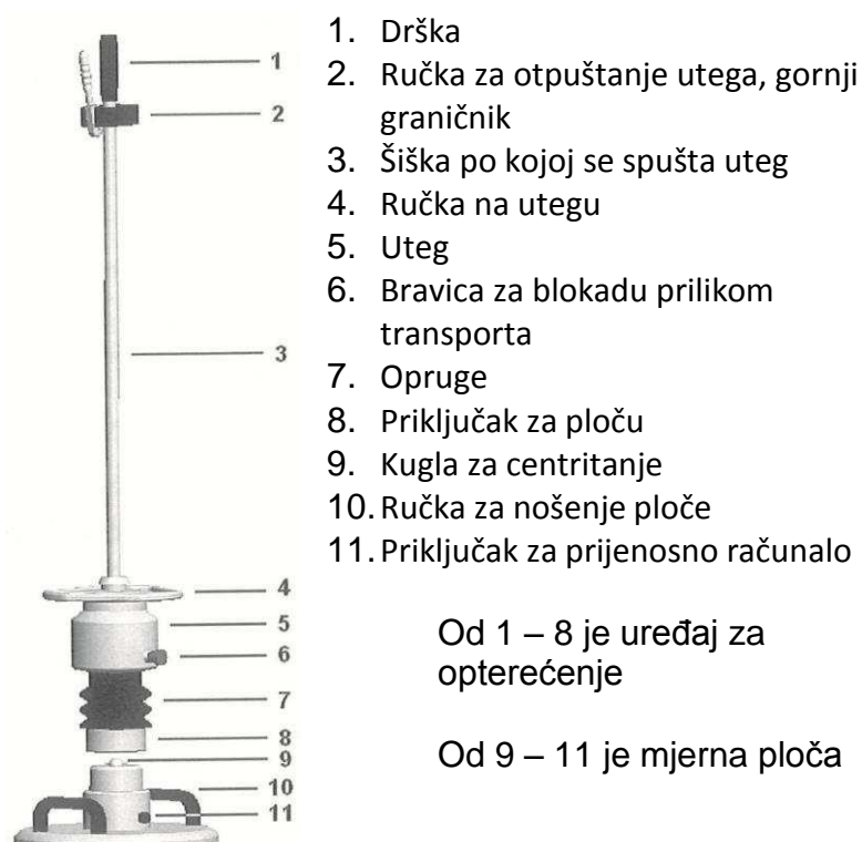
Slika 5. Korišteni deflektometar (Branišelj, S. 2013)
