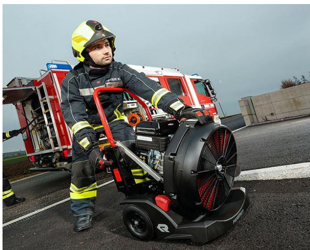
Slika 7. Ventilator za usmjeravanje dima ( https://luveti.hr )
