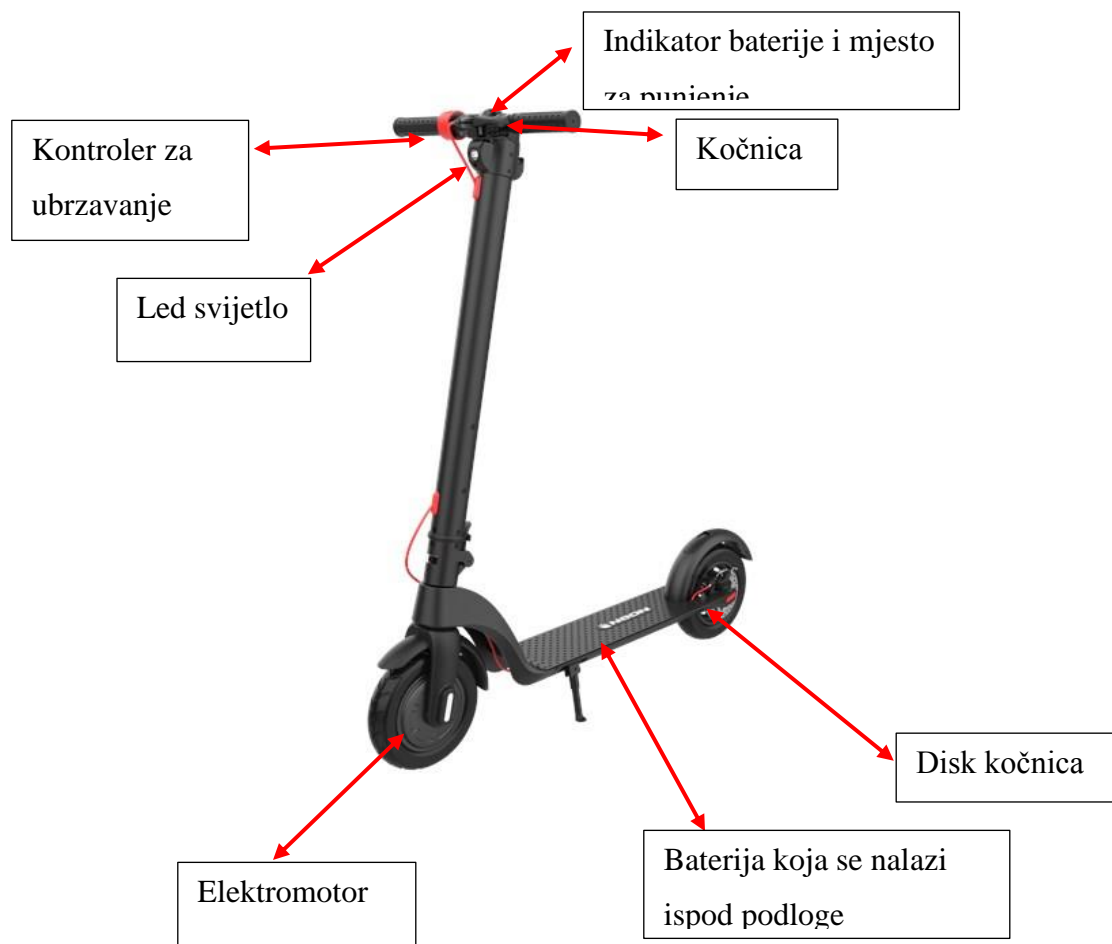
Slika 1. Dijelovi električnog romobila (izvor: www.technostore.hr )
