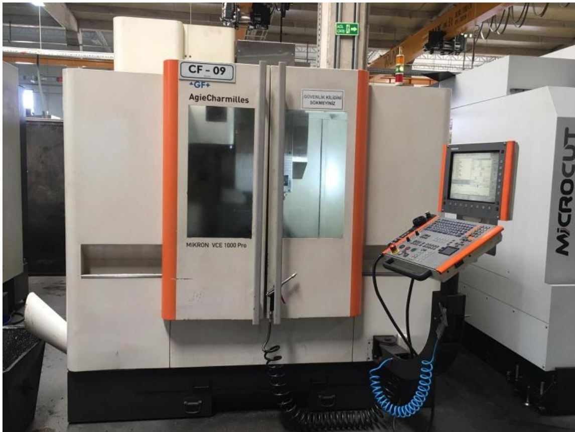
Slika 1. CNC GLODALICA Mikron VCE 1000 Pro [9]
