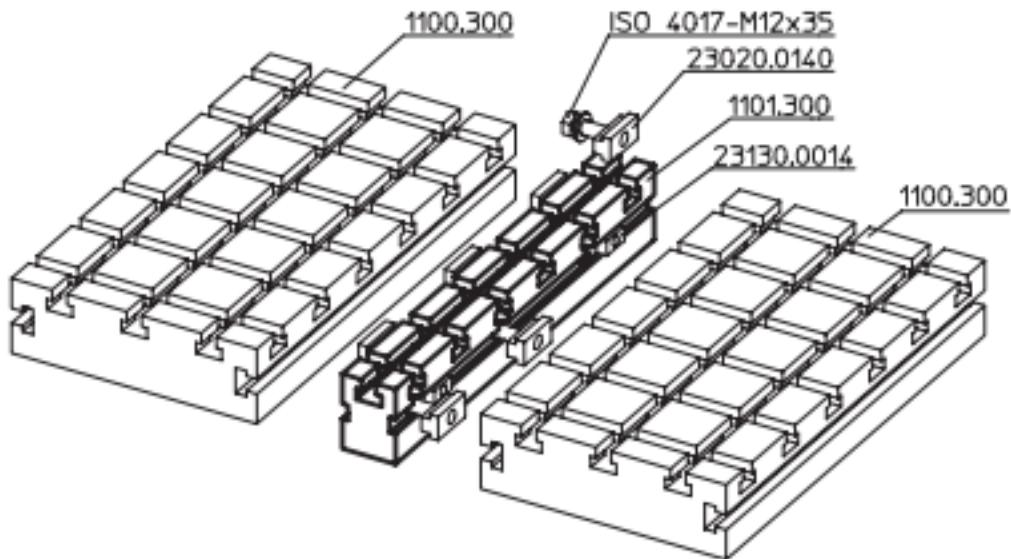
Slika 27. Shematski prikaz spajanja osnovnih ploča spojnim elementom [3]
