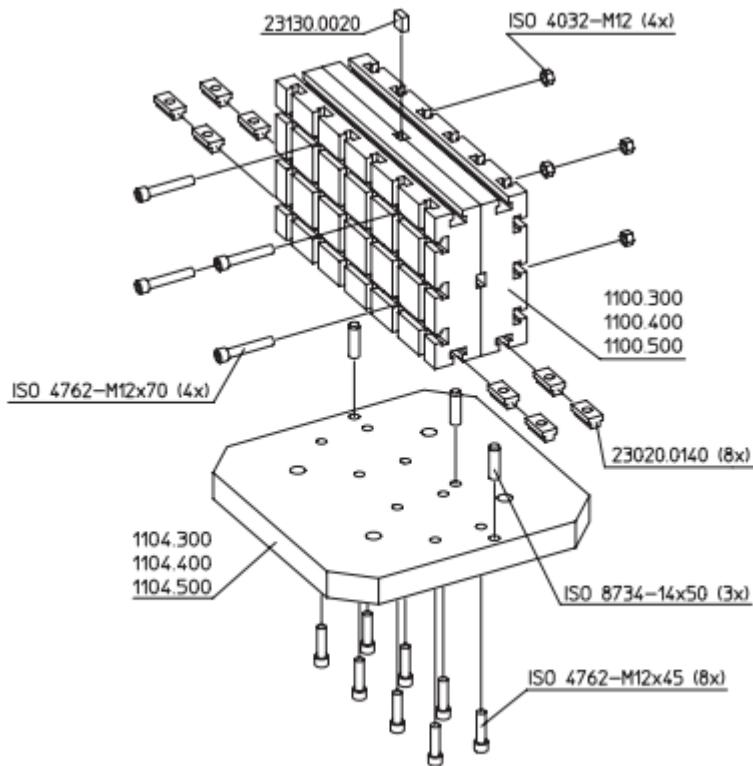
Slika 17. Shematski prikaz spajanja osnovnih ploča [3]
