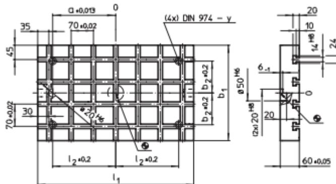
Slika 20. Crtež pravokutne osnovna ploča V70eco 490x300x60 mm [3]
