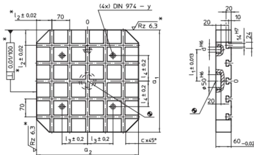
Slika 22. Crtanje kvadratne osnovne ploča V70eco 400x400x60 mm [3]
