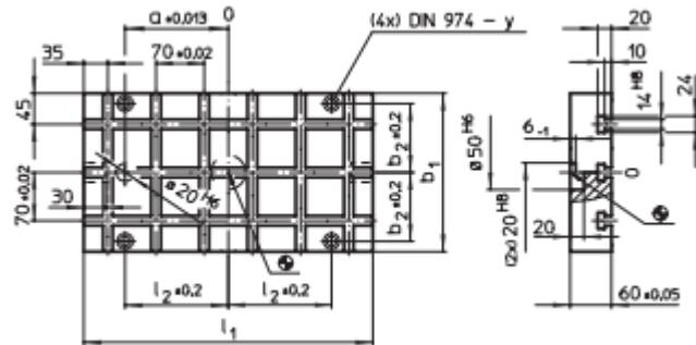
Slika 19. Crtež pravokutne osnovna ploča V70eco 420x230x60 mm [3]
