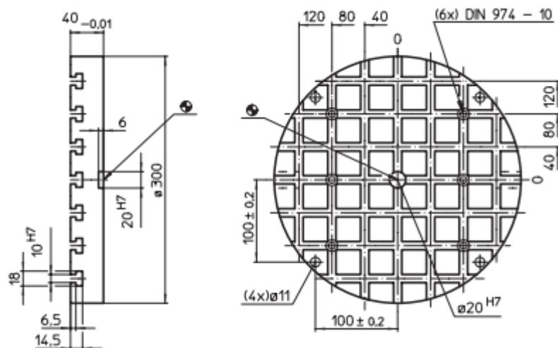
Slika 12. Crtež okrugle osnovne ploče Ø300x40 mm [3]
