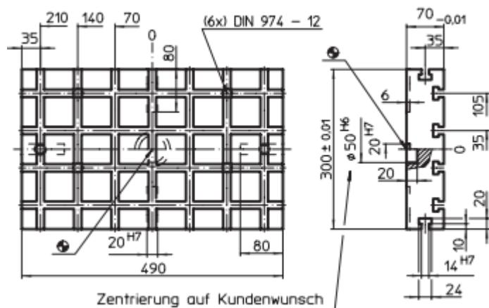
Slika 15. Crtež osnovne ploče 490x300x70 mm [3]
