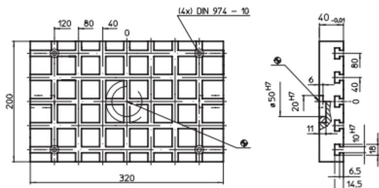
Slika 7. Crtež osnovne ploče 320x200x40 mm [3]
