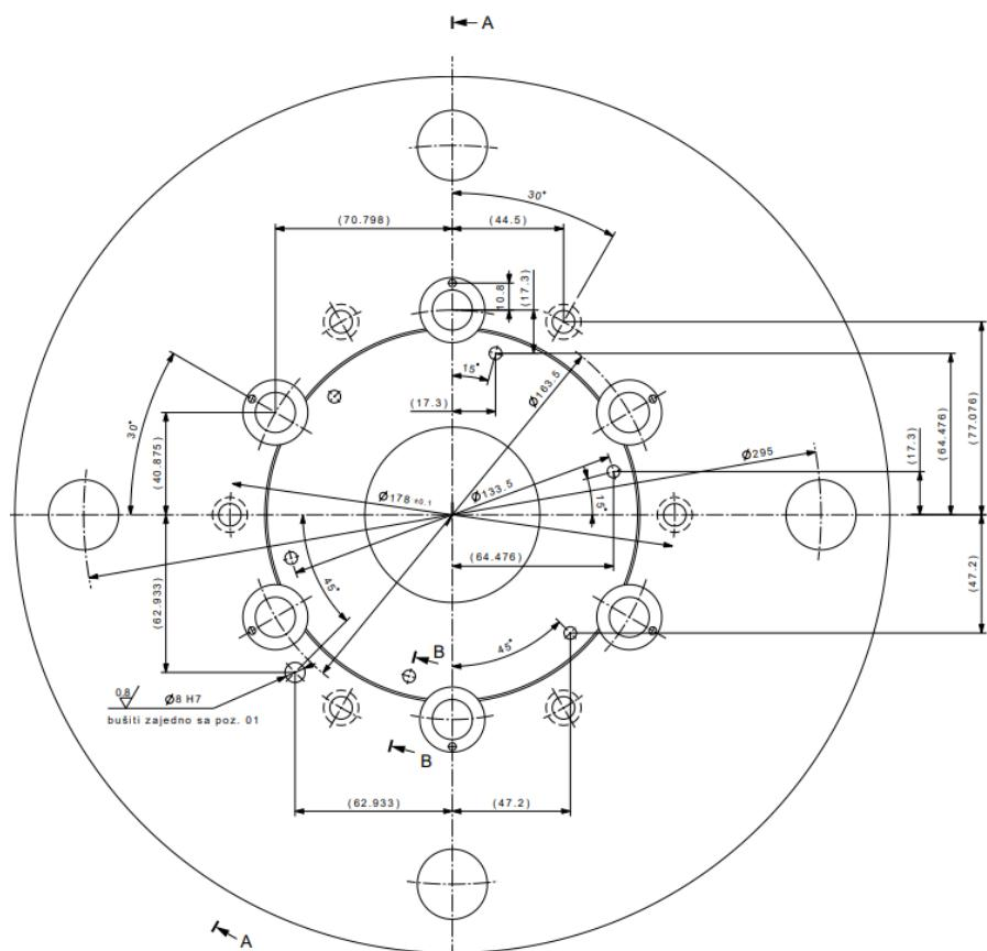
Slika 41. Radionički crtež gornje ploče-nacrt
