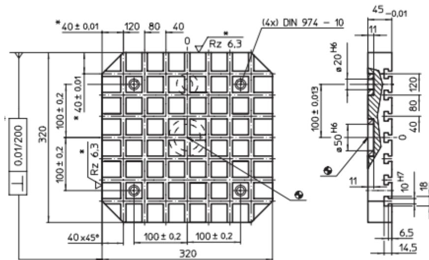
Slika 9. Crtež osnovne ploče 320x320x45 mm [3]
