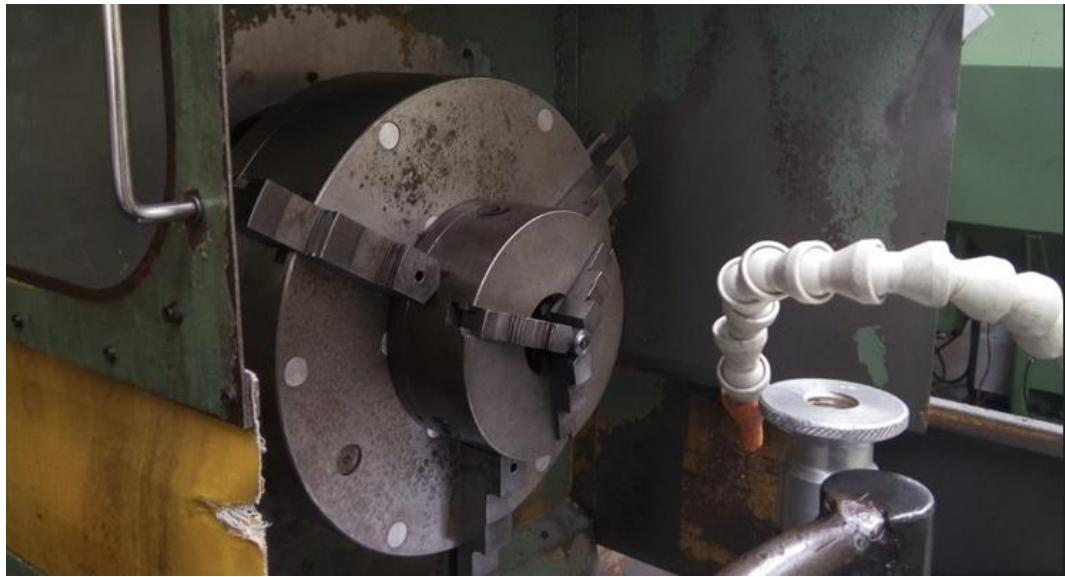
Slika 33. Stezna glava na CNC tokarilici
