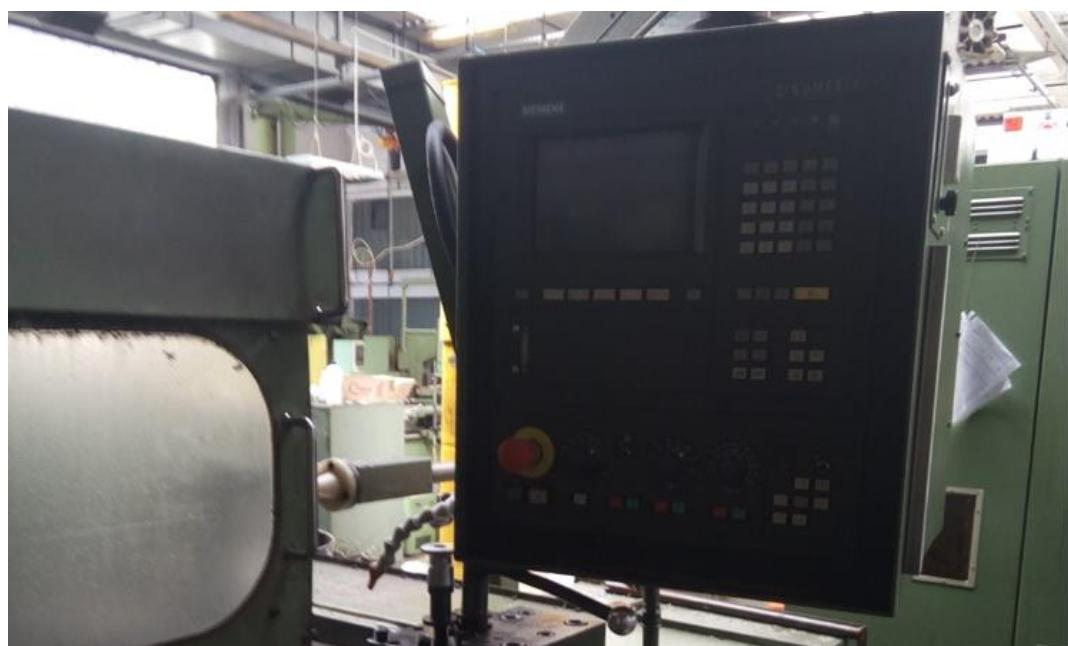
Slika 32. Upravljačka jedinica CNC tokarilice
