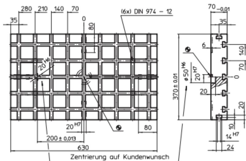
Slika 16. Crtež osnovne ploče 630x370x70 mm [3]
