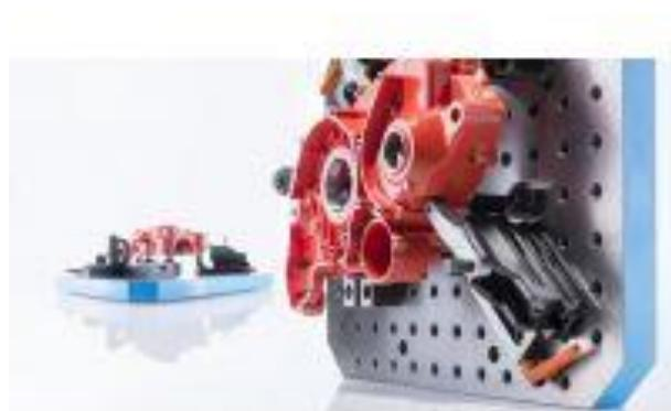
Slika 28. Stezanje obradaka na rupičastoj ploči [3]
