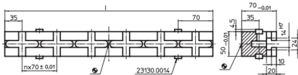
Slika 26. Crtež spojnog elementa za osnovne ploče [3]
