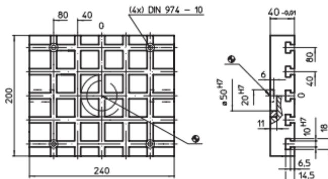
Slika 6. Crtež osnovne ploče 240x200x40 mm [3]
