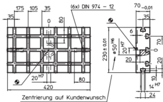
Slika 14. Crtež osnovne ploče 420x230x70 mm [3]
