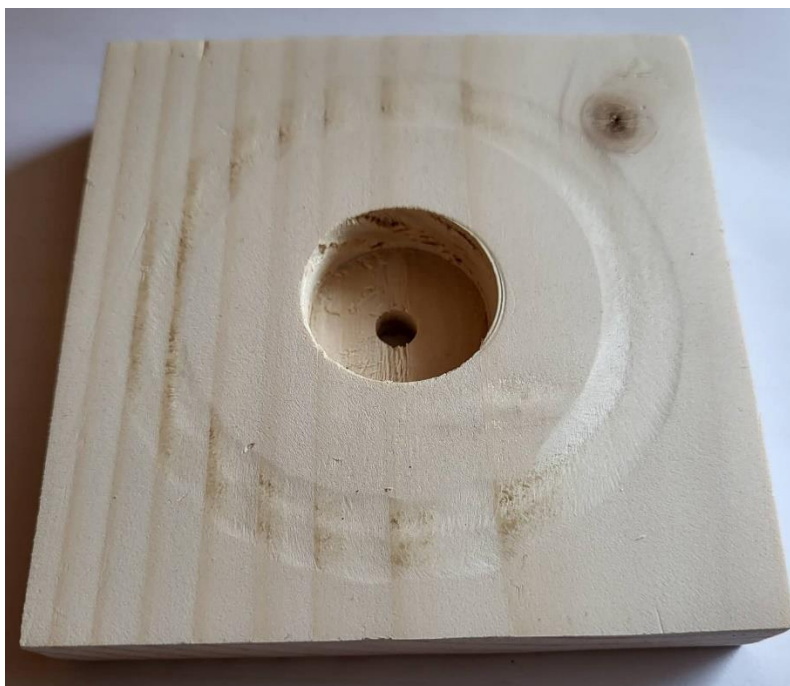
Slika 26. Prikaz uzorka jele nakon ispitivanja
