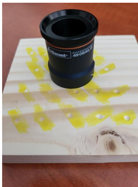
Slika 50. Prikaz mjerenja promjera otiska čelične kuglice
