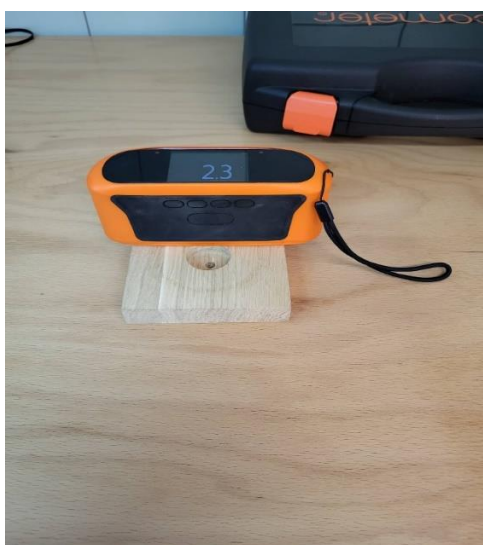
Slika 29. Prikaz uređaja za mjerenje sjajnosti površine
