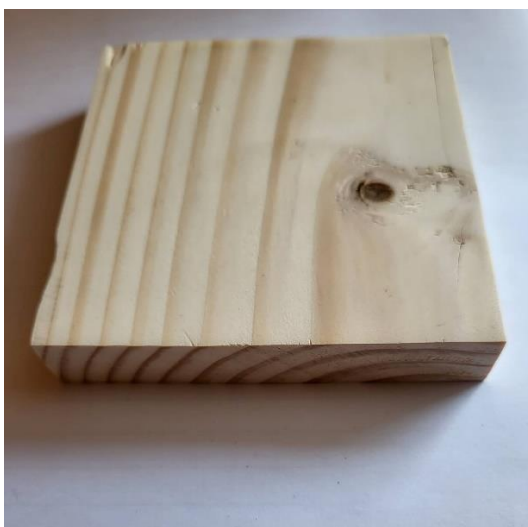
Slika 22. Prikaz uzorka jele prije ispitivanja
