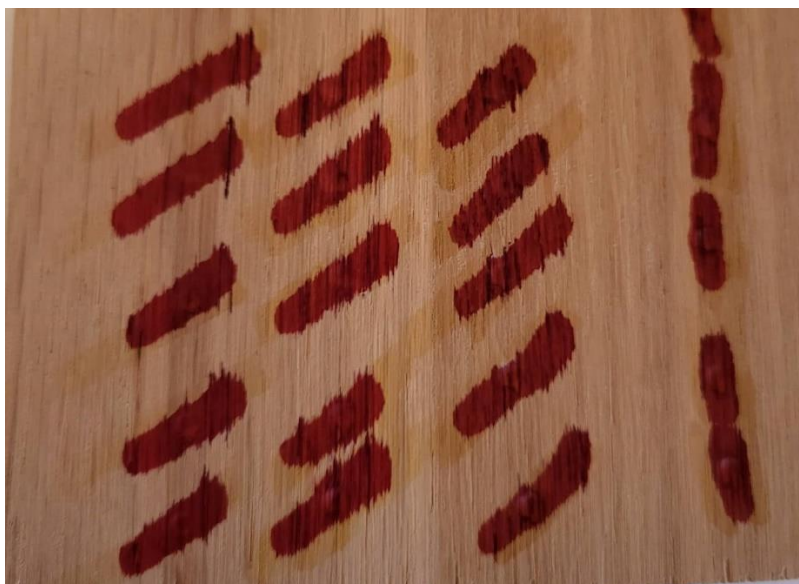
Slika 49. Prikaz otisaka čelične kuglice na uzorku hrastovine
