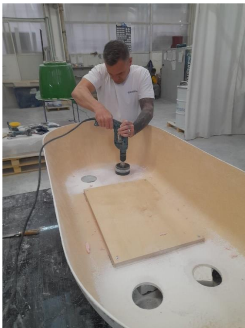
Slika 22. Izrada rupa za sisaljke.
