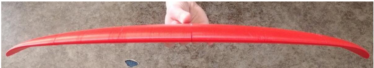
Slika 46-Ispisano prednje krilo (pogled sprijeda)
