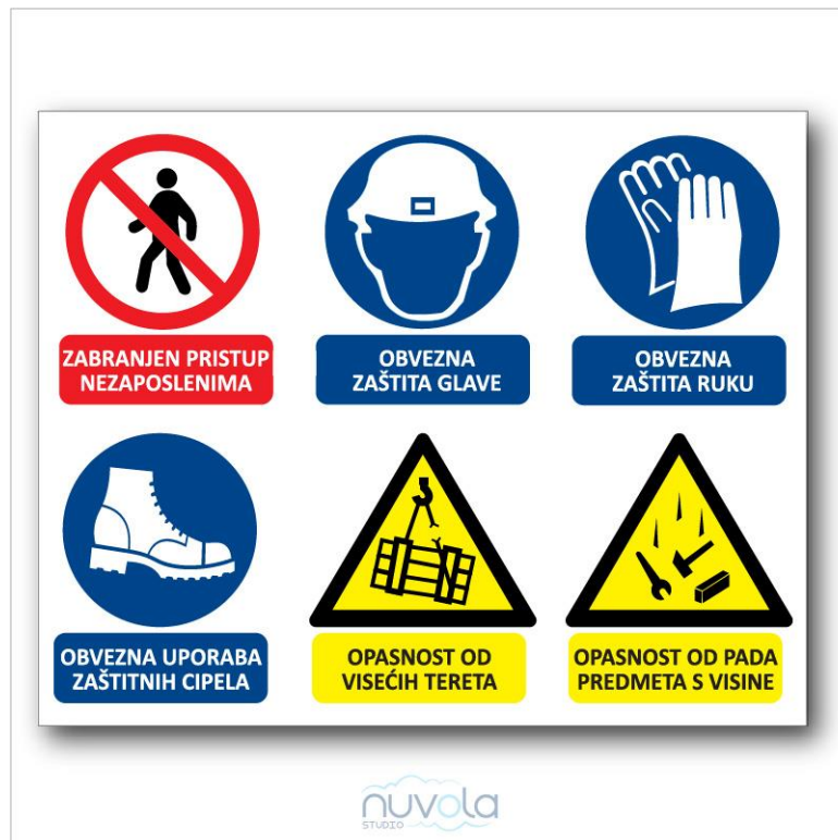
Slika 13. Znakovi upotrebljeni u prostoru rada dizalice [13]
