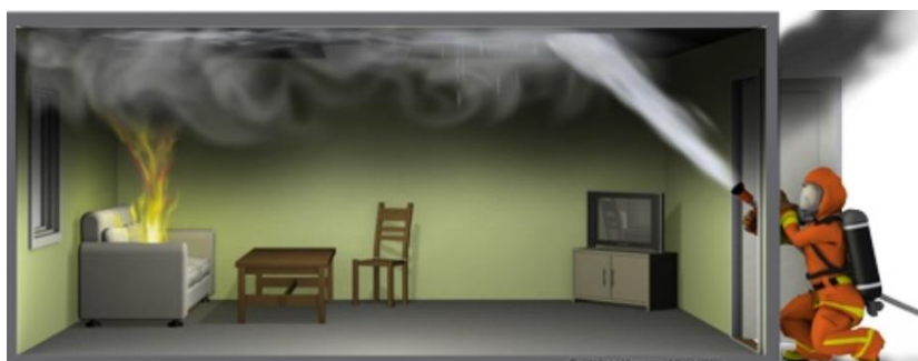
Slika 12. Usmjeravanje mlaza prema stropu [15]
