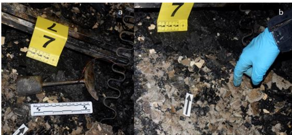
Slika 36. a) Metalna lampa, b) Stakleni balon žarulje [18]
