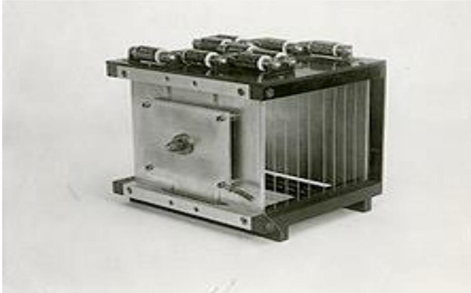
Slika 12. Prenosiva ionizacijska komora
