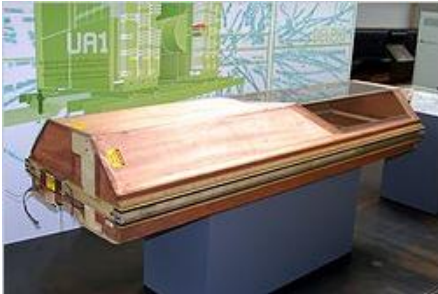
Slika 10. Povlačna komora- jedan oblik višeanodnog proporcionalnog brojača
