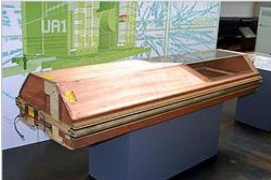
Slika 10. Povlačna komora- jedan oblik višeanodnog proporcionalnog brojača
