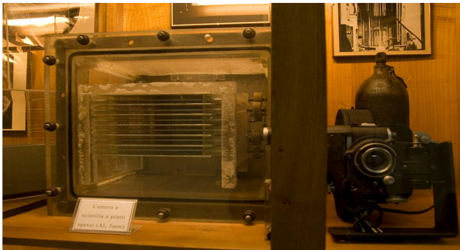
Slika 14. Komora na iskricice u muzeju fizike, u Rimu
