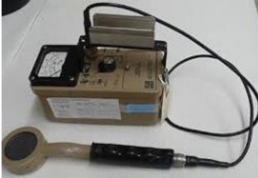
Slika 8. Primjer Geiger-Müllerova brojača
