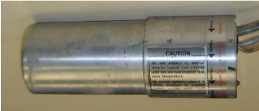
Slika 18. Detektor od germanija posebno visoke čistoće ili HPGe detektor
