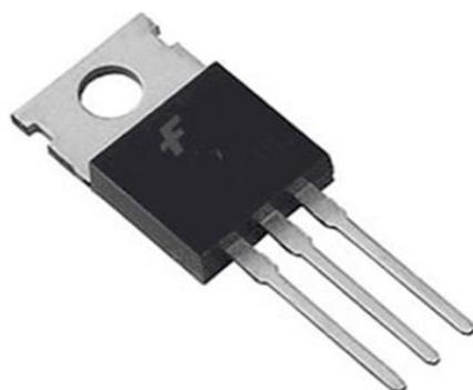
Slika 43. Predodžba LM78xx IC - regulatora napona
