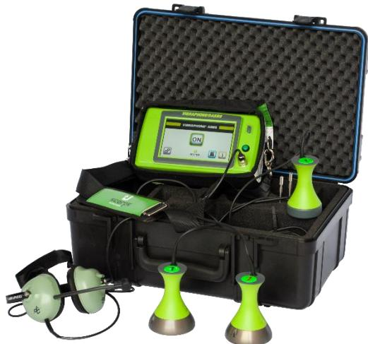
Slika 14. Uređaj vibrofon.[12]
