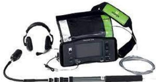
Slika 13. Uređaj vibroskop.[11]
