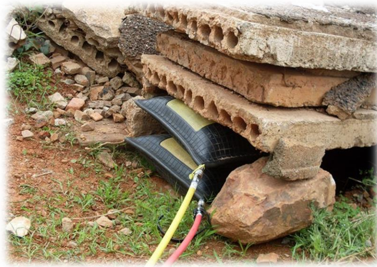
Slika 18. Rad sa pneumatskim zračnim jastucima.[17]
