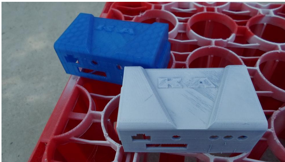
Slika 35. PLA proizvod nakon i prije nanošenja prevlake
