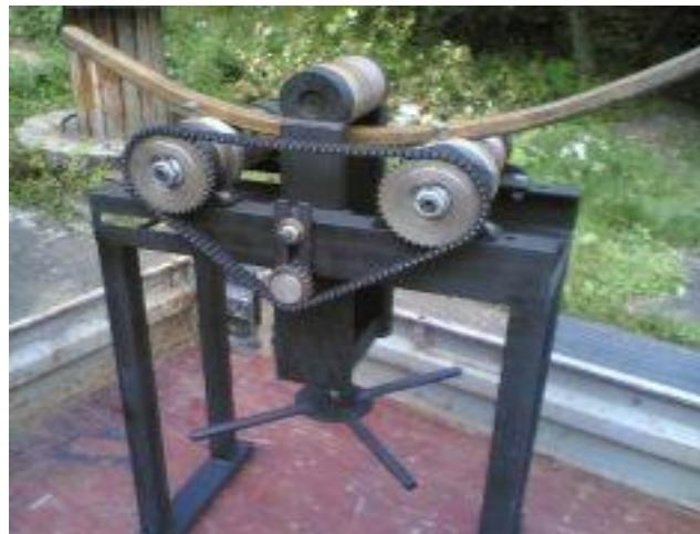
Slika 5. Stroj za savijanje cijevi
