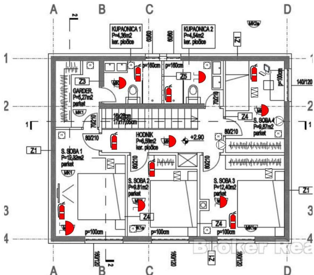
Slika 25. Tlocrt kata sa elementima tehničke zaštite
