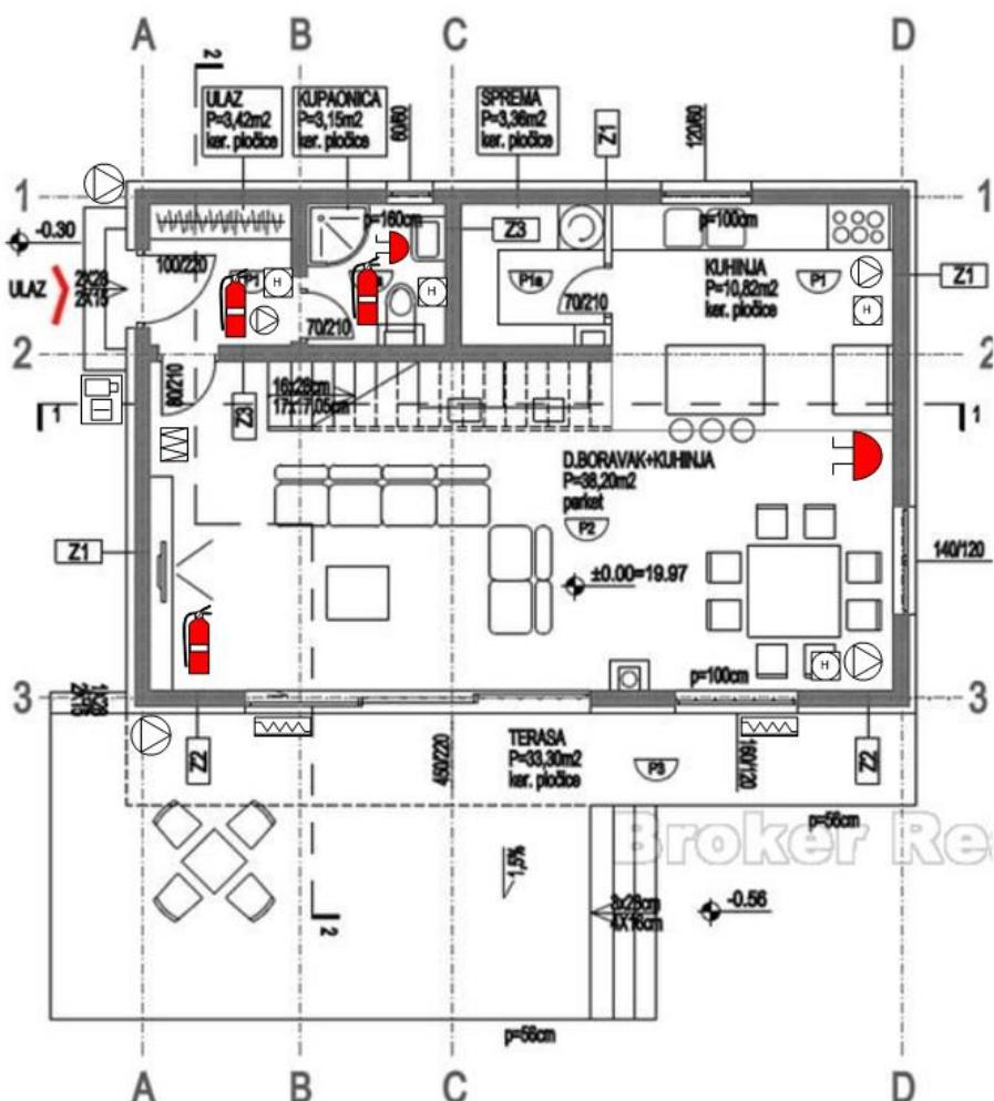
Slika 24. Tlocrt prizemlja s elementima tehničke zaštite
