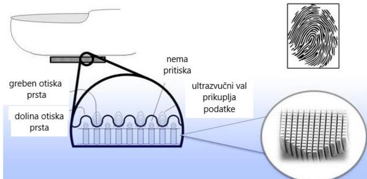
Slika 18. Predodžba rada ultrazvučnog skenera: izvorno autorica
