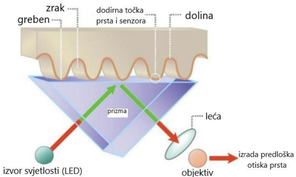
Slika 15. Predodžba rada optičkog skenera: Izvorno autorica
