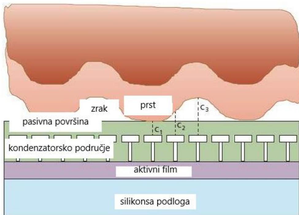
Slika 16. Predodžba rada kapacitivnog skenera: Izvorno autorica
