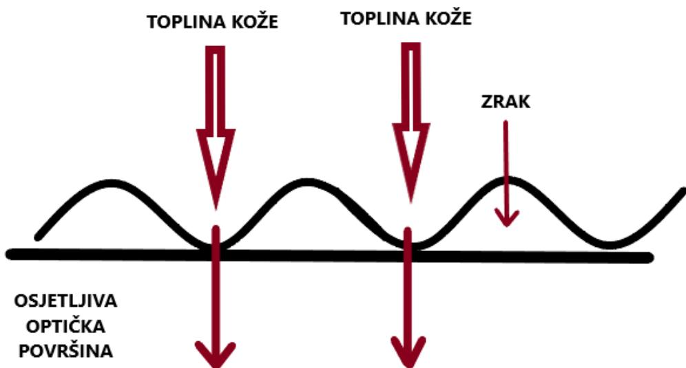
Slika 17. Predodžba rada termalnog skenera: Izvorno autorica
