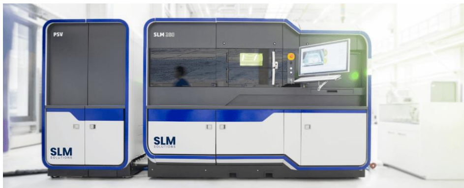
Slika 13. Stroj za selektivno lasersko taljenje [8]
