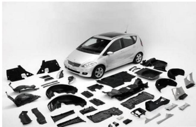
Slika 3. Dijelovi za eksterijer automobila napravljeni pomoću postupka injekcijskog prešanja [3]
