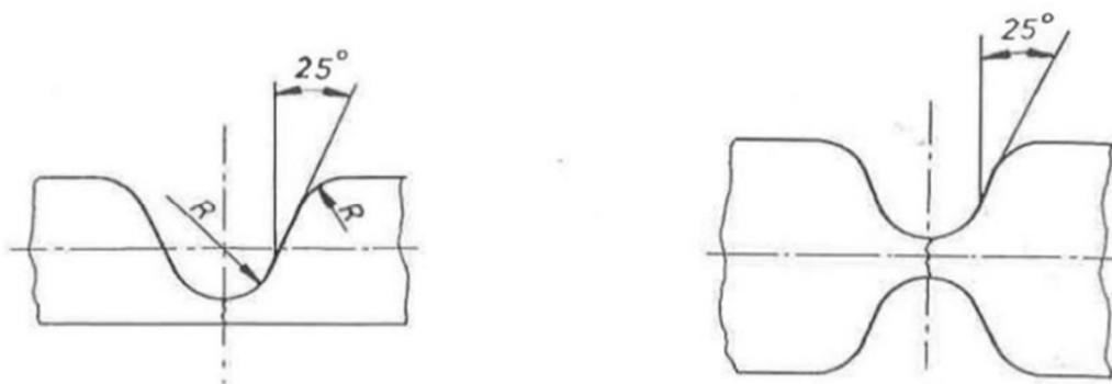
Slika 15. Oblik žlijeba za zavarivanje nodularnog lijeva na hladno
