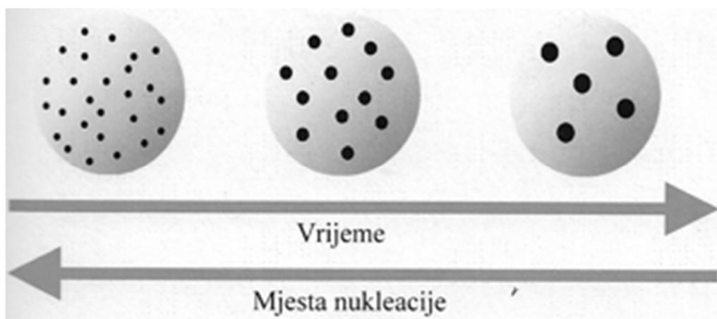
Slika 11. Shematski prikaz pogrubljenja uključaka Ostwaldovim sazrijevanjem [11]
