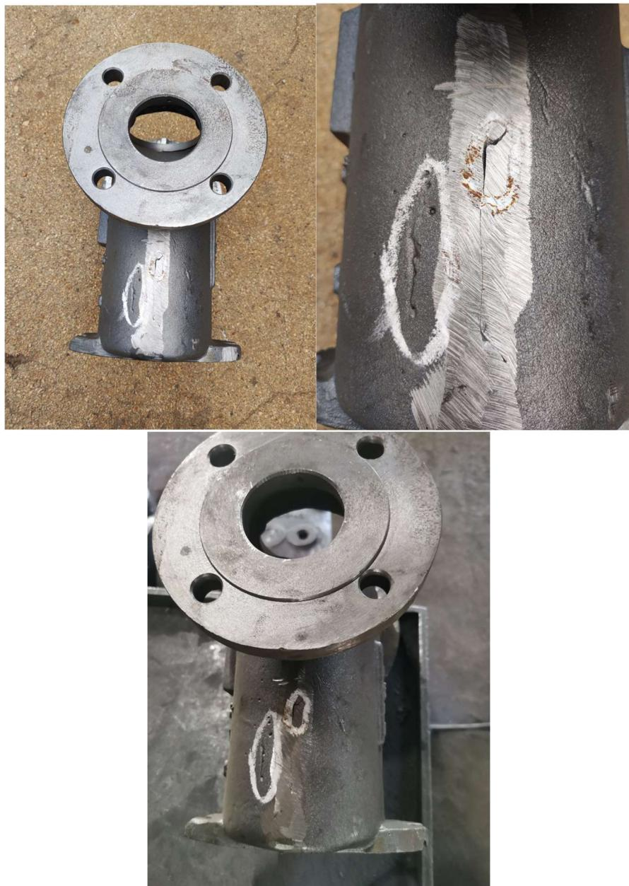
Slika 27. Indicirana greška na kućištu filtara KSF DN65
