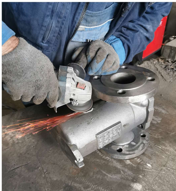
Slika 31. Brušenje zavara nakon zavarivanja pukotine
