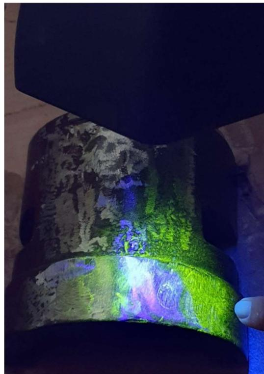
Slika 17 Ispitivanje ležaja magnetskog metodom
