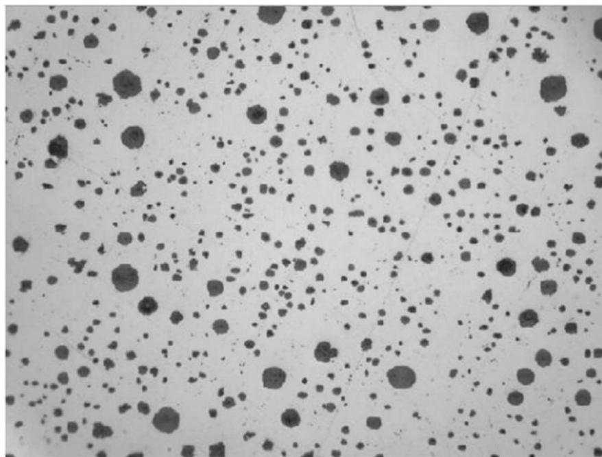
Slika 2. Nodularni lijev - feritno-perlitne mikrostrukture [2]
