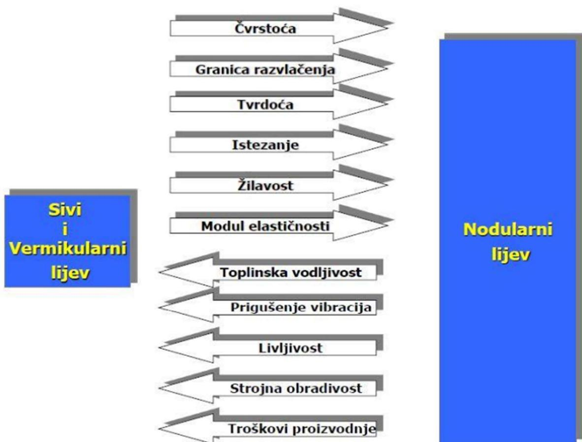
Slika 1. Usporedba svojstava nodularnog, sivog i vermicularnog lijeva [1]
