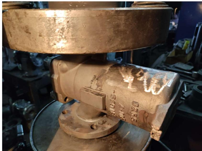
Slika 33. Ispitivanje odljevka na tlačnoj probi
