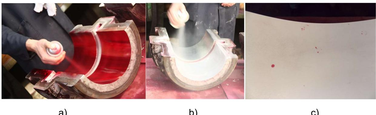
Slika 16 a) nanošenje penetranta na strojni obradak; b) nanošenje razvijača; c) uočene greške
