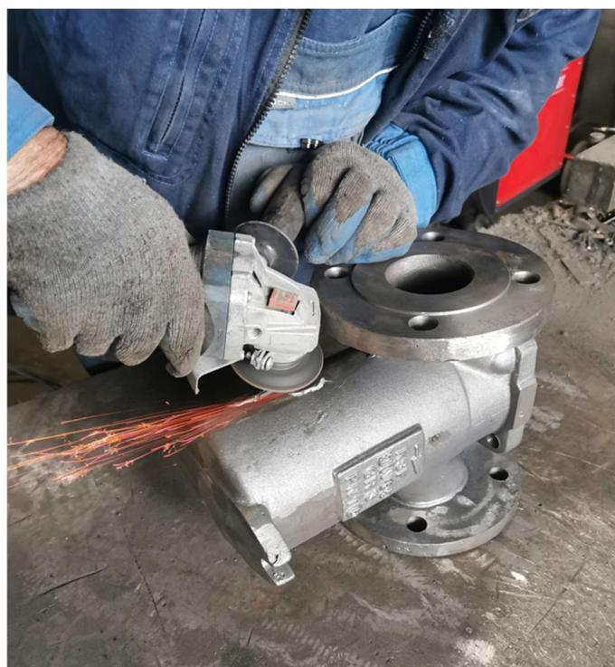
Slika 31. Brušenje zavara nakon zavarivanja pukotine
