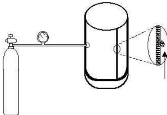
Slika 19. Kontrola nepropusnosti tlačenjem fluida u zavarenoj posudi [20]
