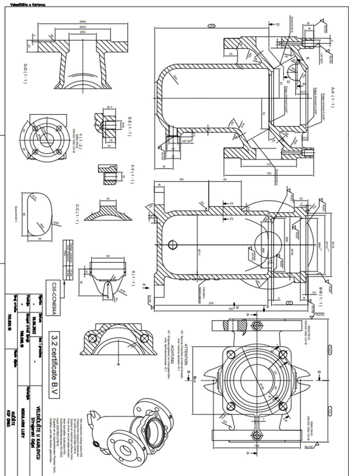
Slika 22. Nacrt kućišta filtra KSF DN65 GR3 PN16
