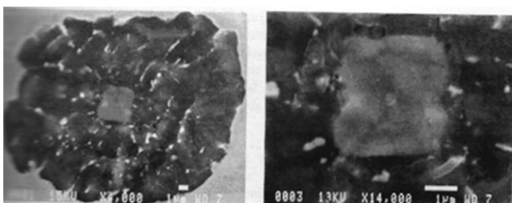
Slika 10. Nuklacija grafita na uključcima A tipa (snimke načinjene pretražnim elektronskim mikroskopom (SEM)) [10]
