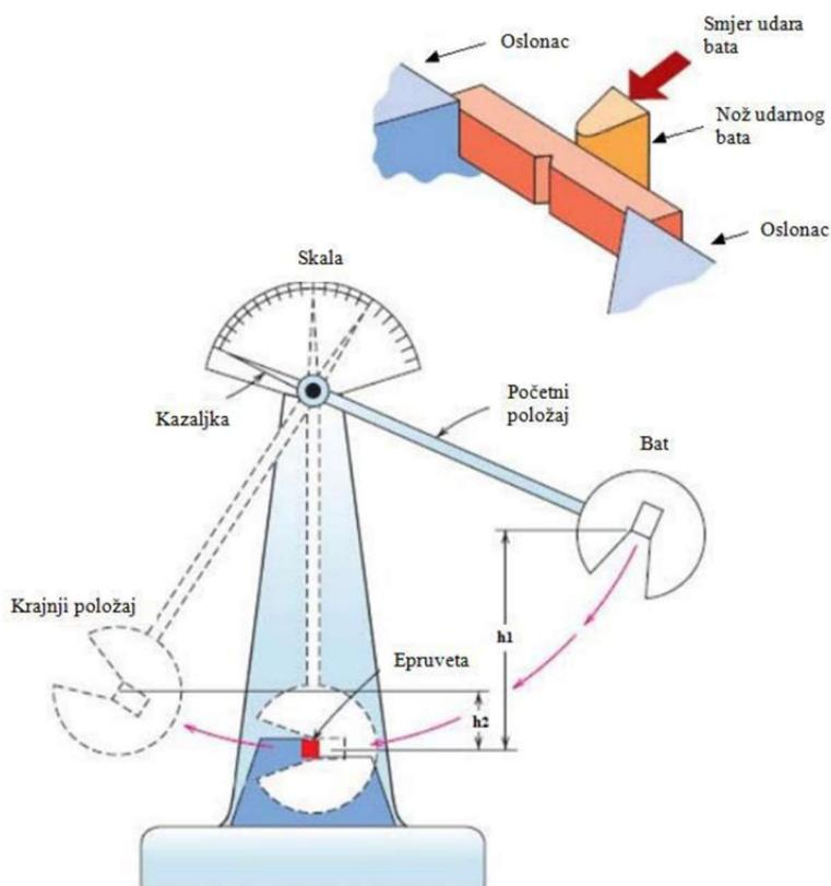
Slika 21. Sharpy-ev bat (uređaj za ispitivanje udarne žilavosti) [24]
