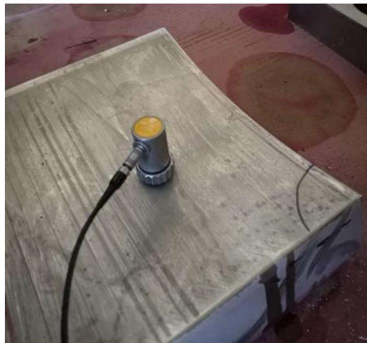
Slika 18. Ultrazvučno ispitivanje
