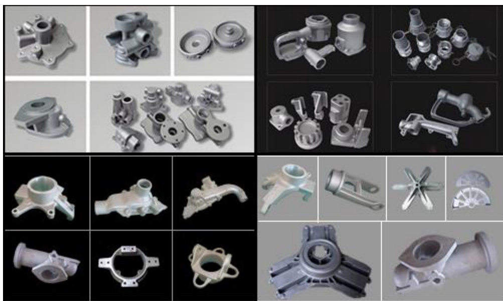
Slika 3. Primjerci odljevaka lijevanjem u kokile [4]
