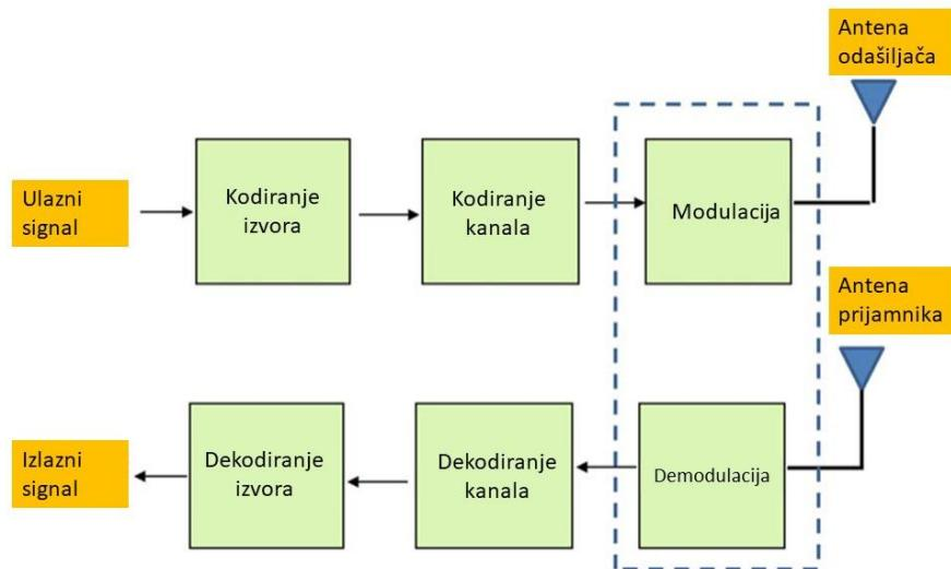
Slika 1. Blok shema, prikaz modernog komunikacijskog sustava [2]
