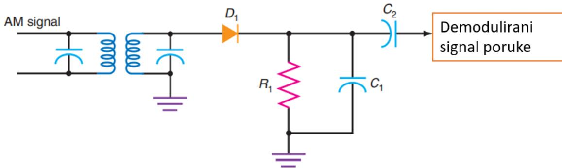
Slika 15. Prikaz dioda detektor demodulator sklopa [3]
