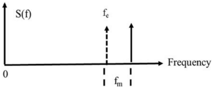
Slika 20. Spektar SSB modulirtanog signala [2]
