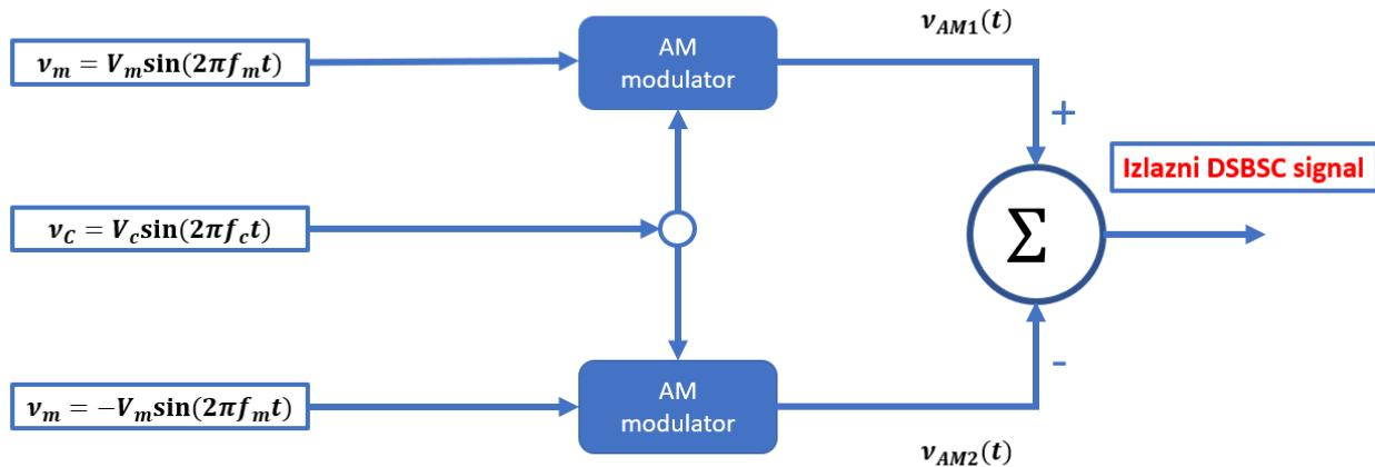
Slika 18. Blok prikaz DSBSC modulatora
