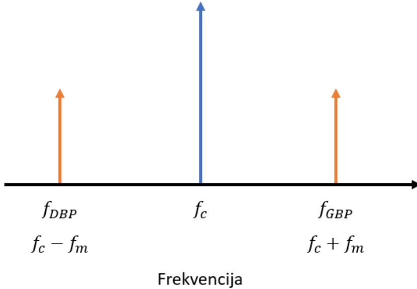
Slika 12. Priklaz AM signala u frekvencijskoj domeni
