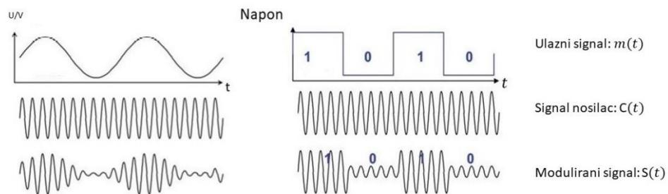
Slika 4. Prikaz analognog i digitalnog amplitudno moduliranog signala
