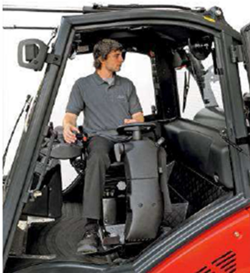
Slika 24. Model Linde viličara sa zaokretnom konzolom sjedišta
