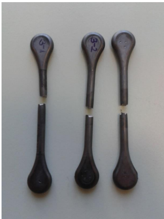
Slika 33.: MIM i HIP epruvete nakon ispitivanja
