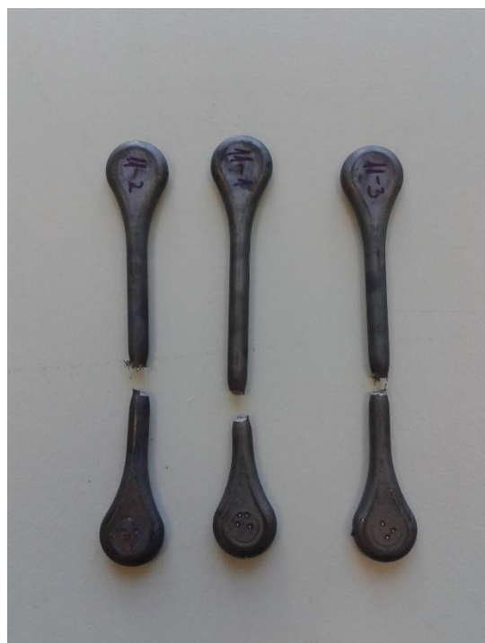
Slika 33.: MIM i HIP epruvete nakon ispitivanja
