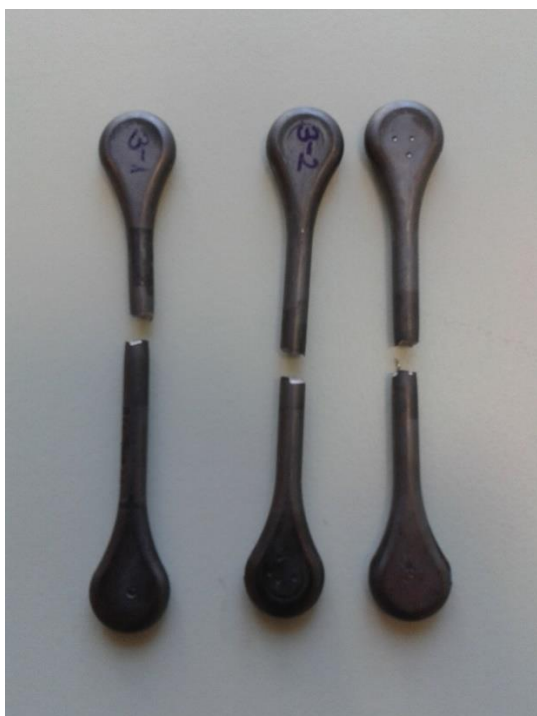
Slika 33.: MIM i HIP epruvete nakon ispitivanja
