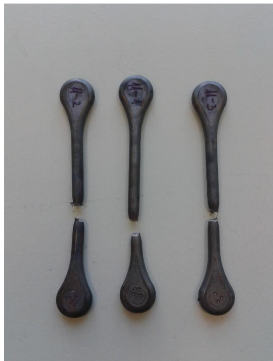
Slika 33.: MIM i HIP epruvete nakon ispitivanja
