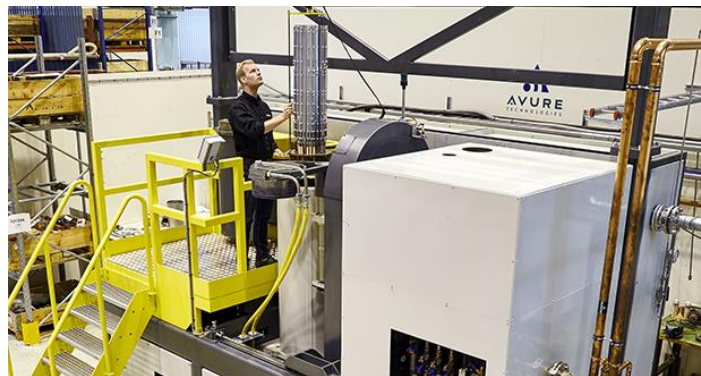
Slika 13.: Postrojenje i peć za vruće izostatičko prešanje
