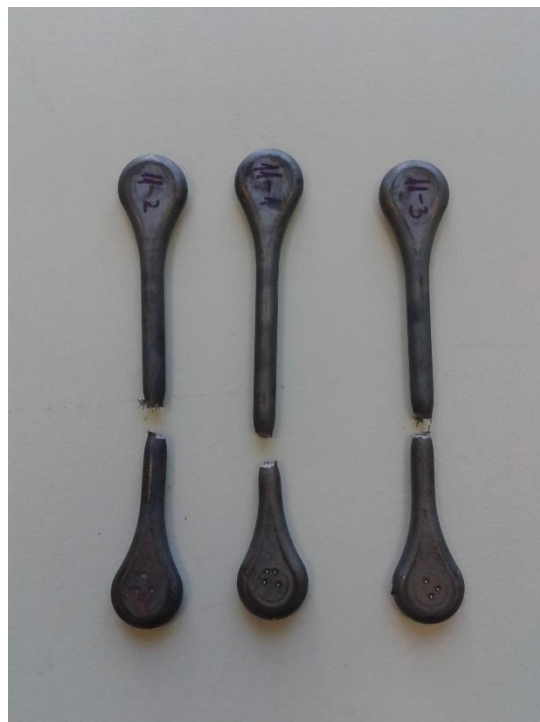
Slika 33.: MIM i HIP epruvete nakon ispitivanja
