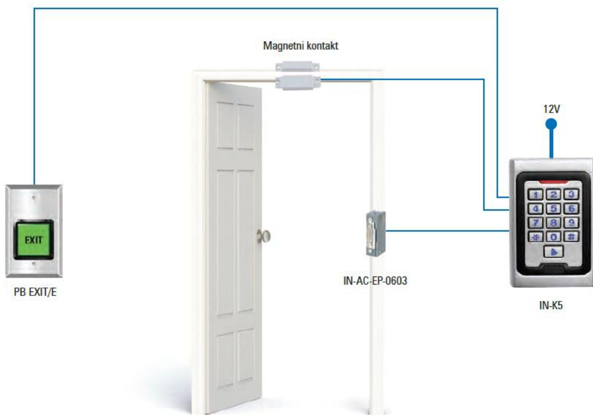
Slika 9. Sustav kontrole pristupa [2]
