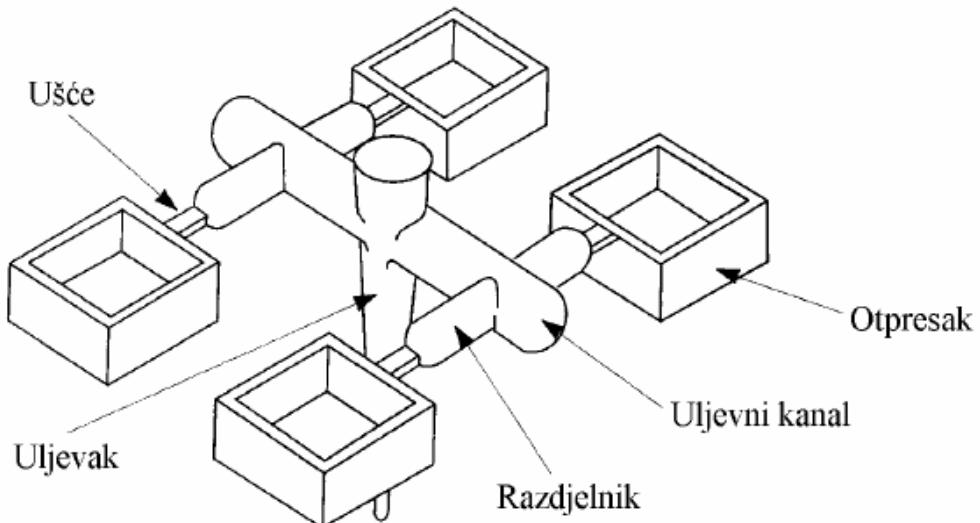
**Slika 2. Elementi čvrstog uljevnog sustava [2]**
