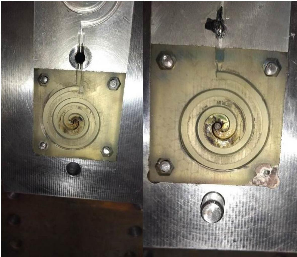
Slika 61. Izgled kalupa nakon trideset otpresaka
