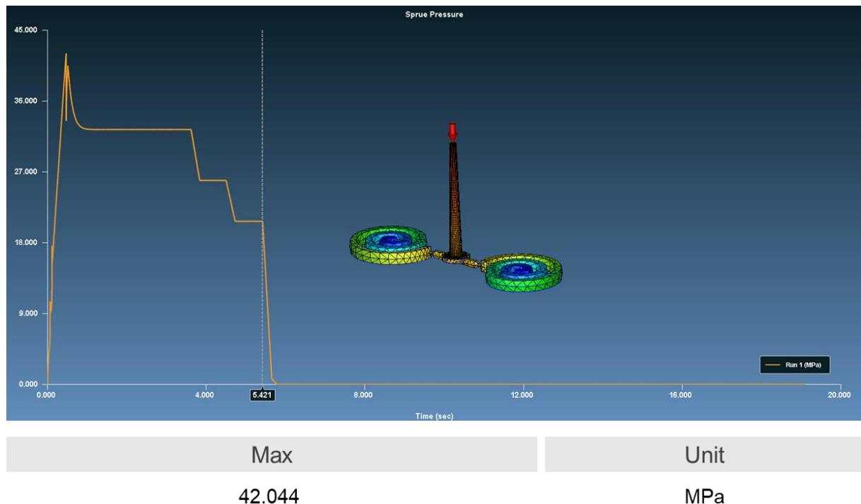
**Slika 31. Tlak uljevka kod faze naknadnog tlaka**
