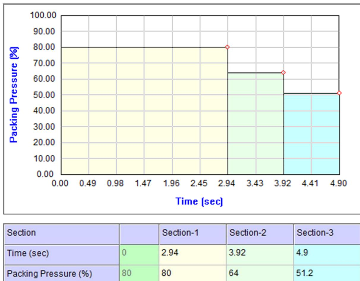
Slika 30. Faza naknadnog tlaka u jedinici vremena
