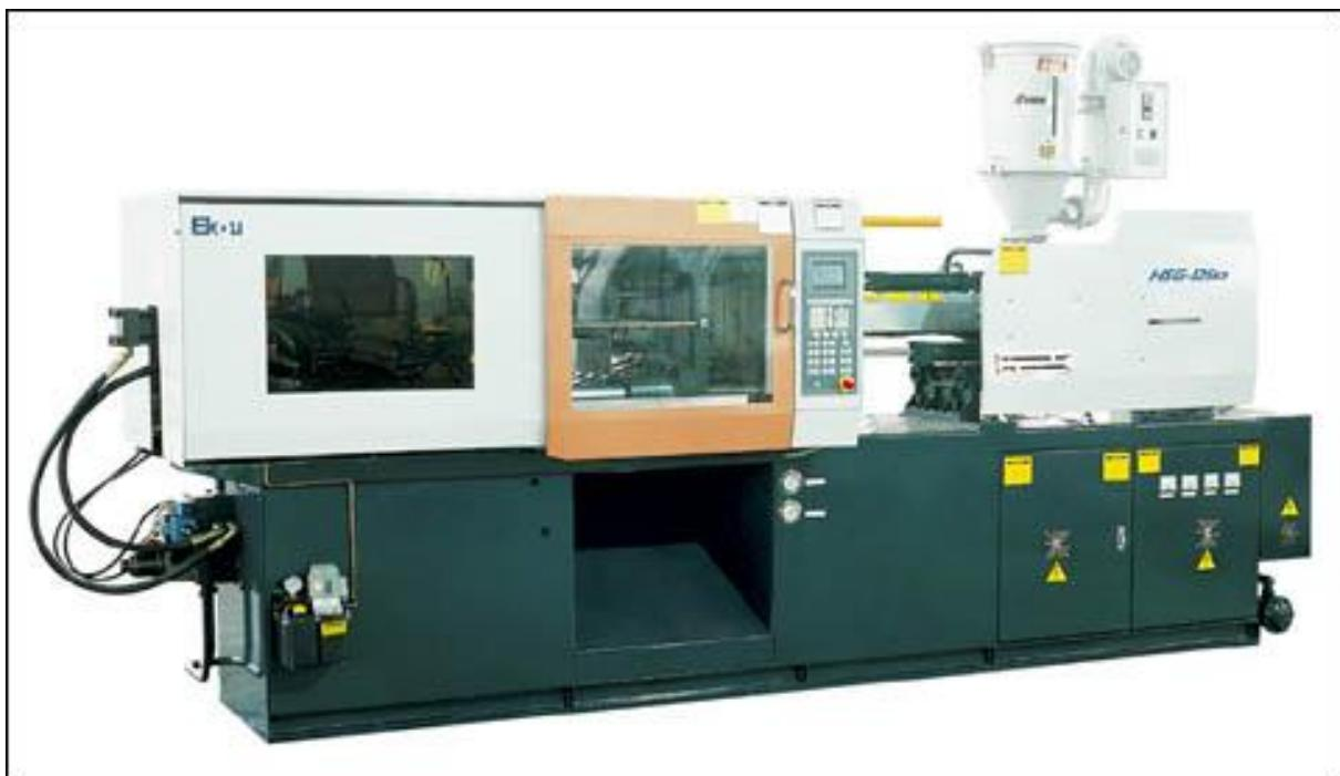
Slika 46. Stroj za injekcijsko prešanje "Ekou HS – 120 K3" [22]
