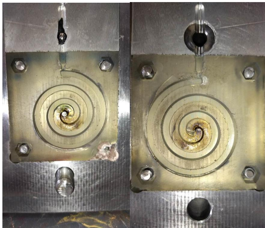
Slika 67. Izgled polimernog kalupa nakon šezdeset otpresaka
