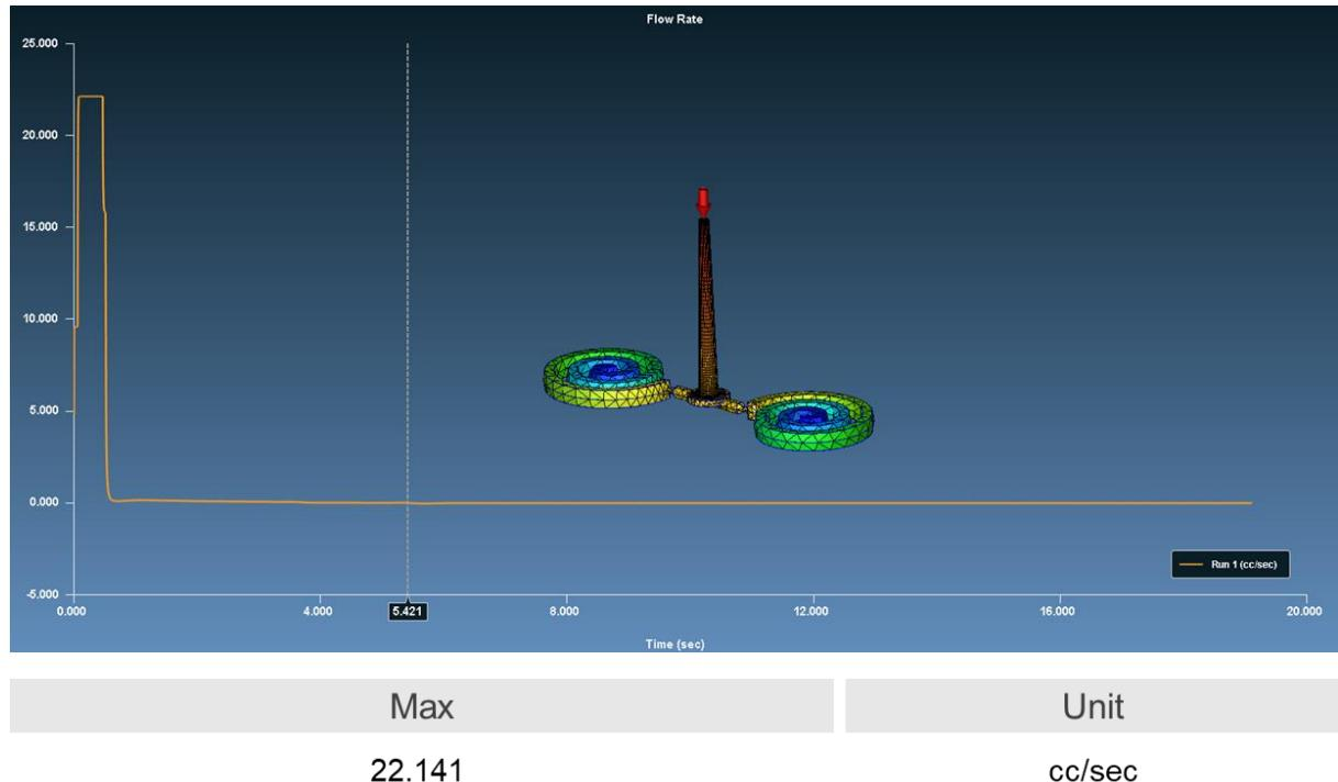
**Slika 33. Tijek taljevine polimernog materijala kod faze naknadnog tlaka**
