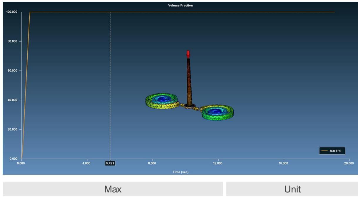
**Slika 34. Volumen taljevine polimernog materijala kod faze naknadnog tlaka**
