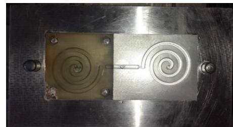
Slika 9. Pomični alat sa polimernim kalupom za drugi i treći postupak injekcijskog prešanja
