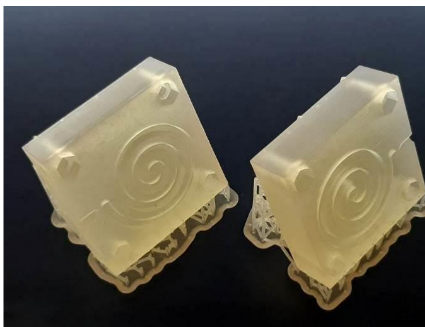
Slika 45. Izgled drugog kalupa aditivne tehnologije u fizičkom obliku
