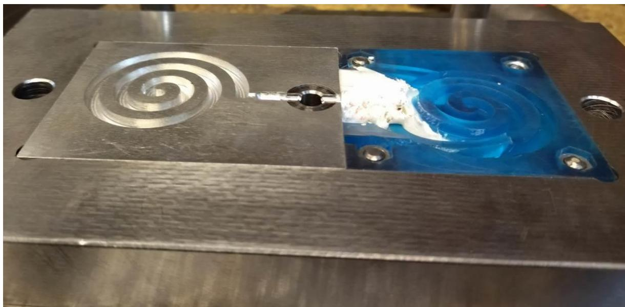
Slika 50. Oštećeni polimerni kalup prvog eksperimenta injekcijskog prešanja (2)
