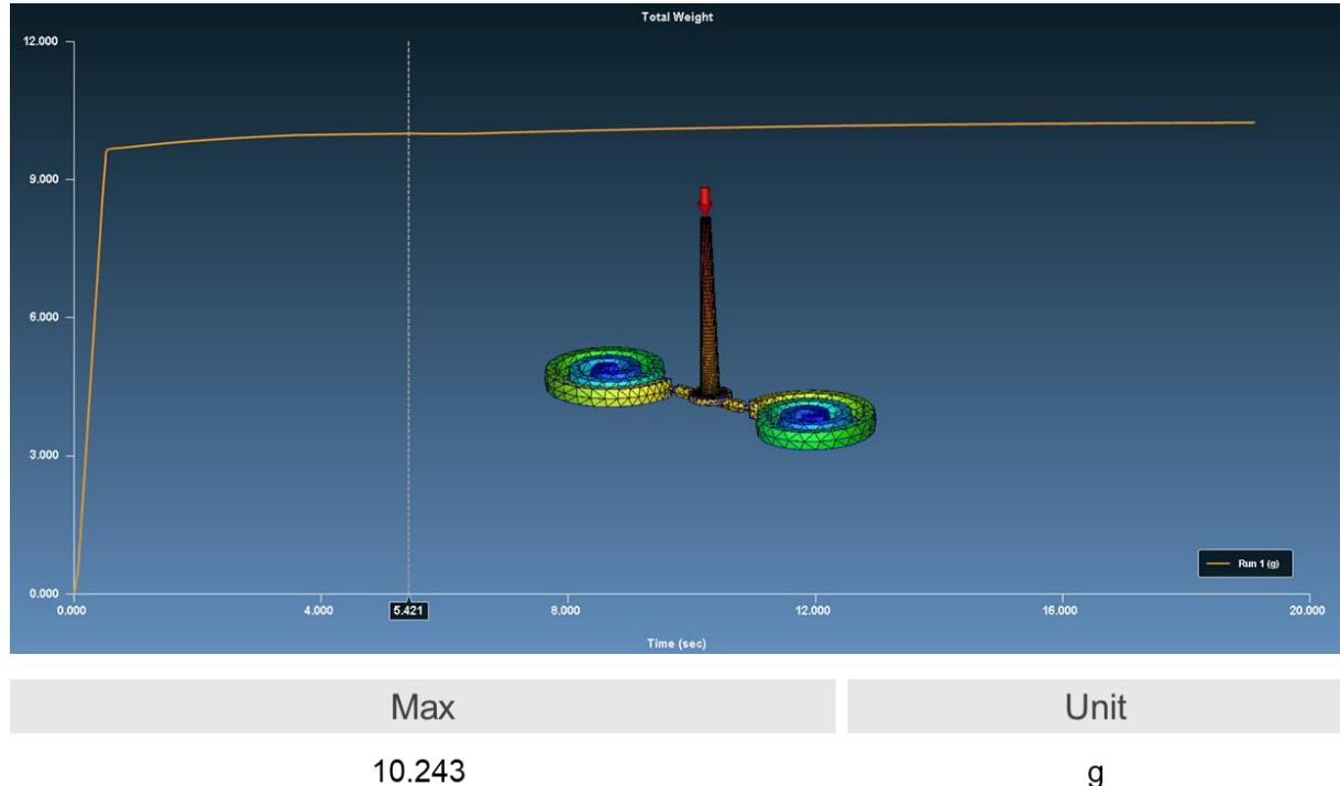
**Slika 35. Masa otpreska s uljevkom u fazi naknadnog tlaka**
