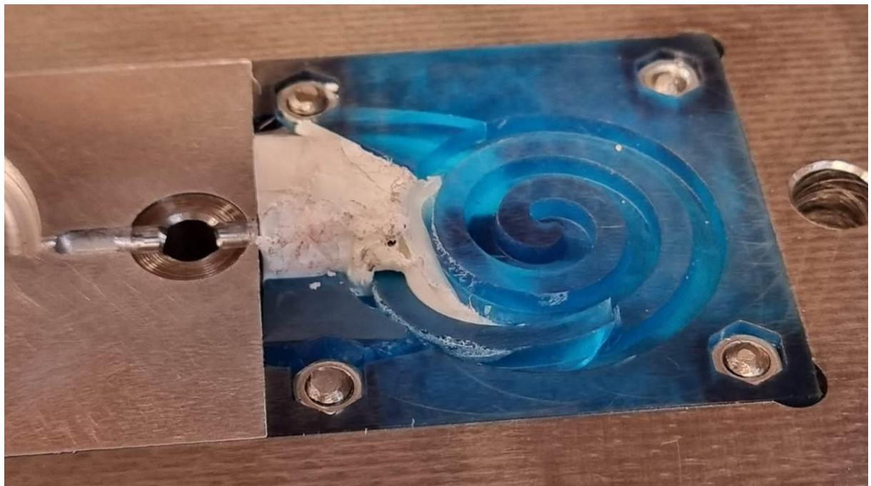
Slika 49. Oštećeni polimerni kalup prvog eksperimenta injekcijskog prešanja (1)
