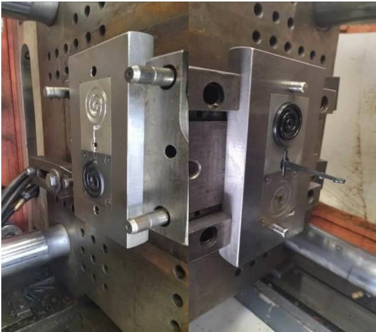
Slika 57. Izgled kalupa nakon prvih deset otpresaka
