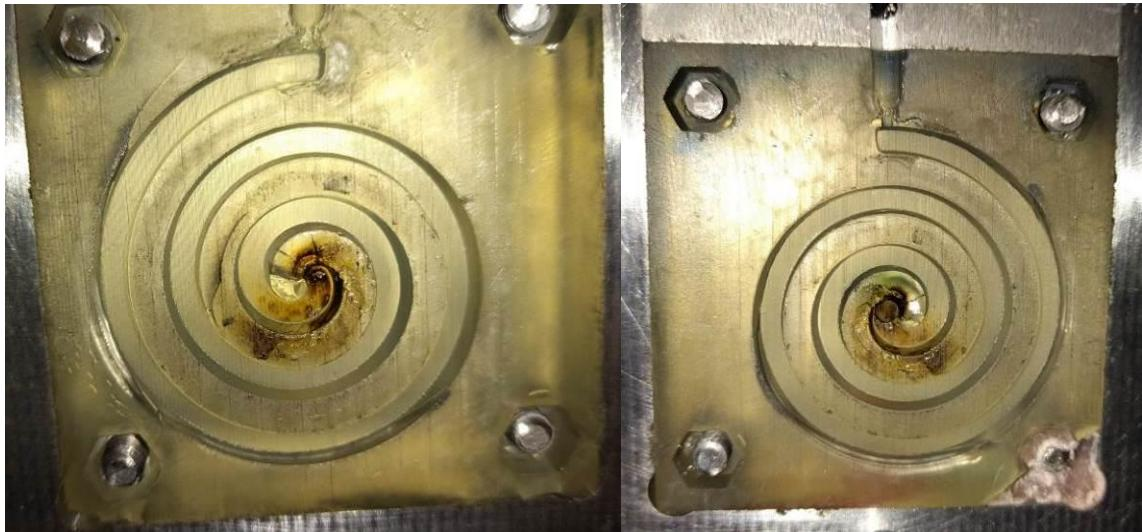
Slika 66. Izgled polimernog kalupa nakon pedeset otpresaka
