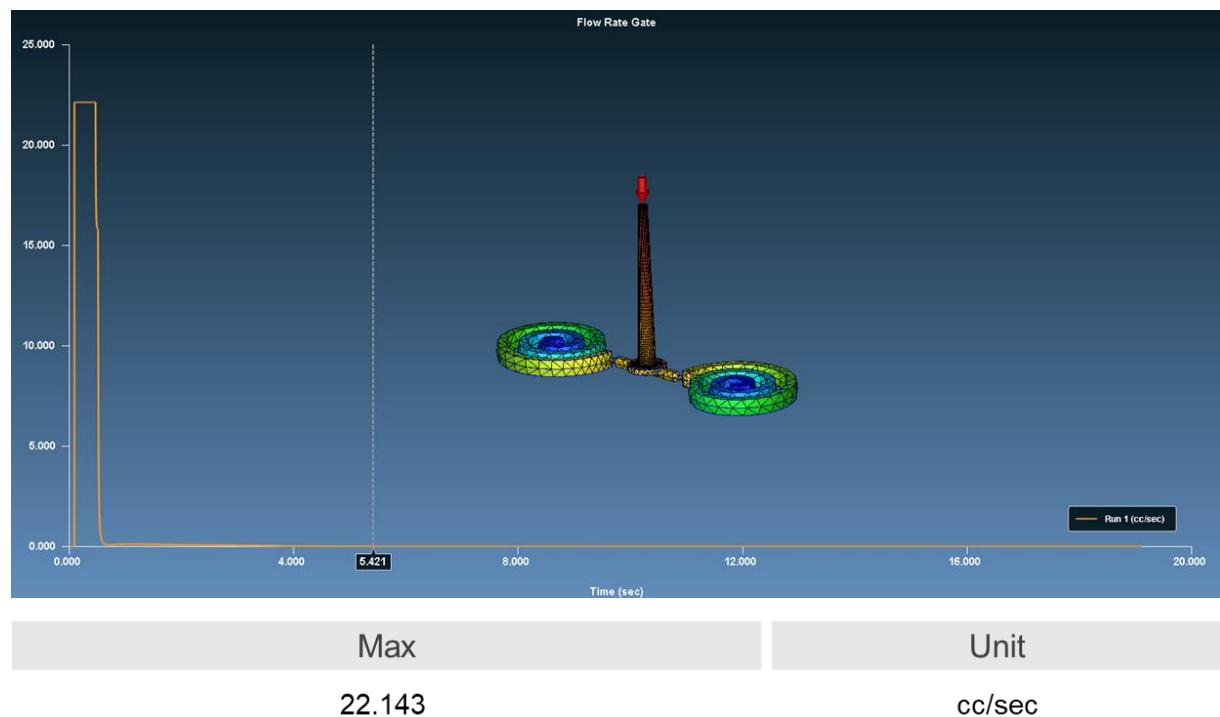
**Slika 37. Tijek taljevine polimernog materijala kroz uljevak**
