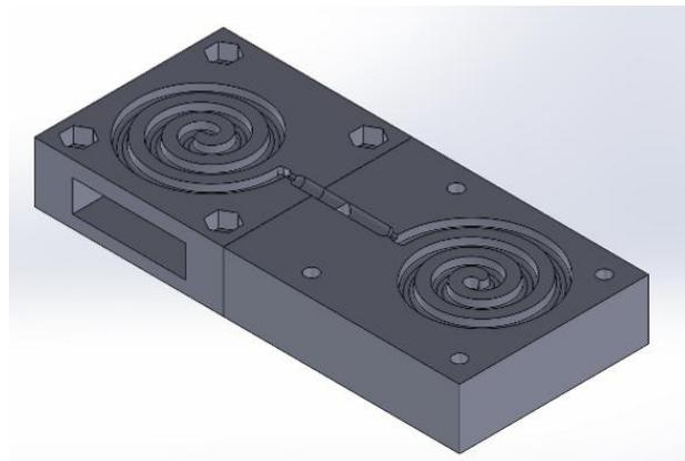
**Slika 5. Presjek kalupa za ispitivanje popunjavanja polimerne mase**
