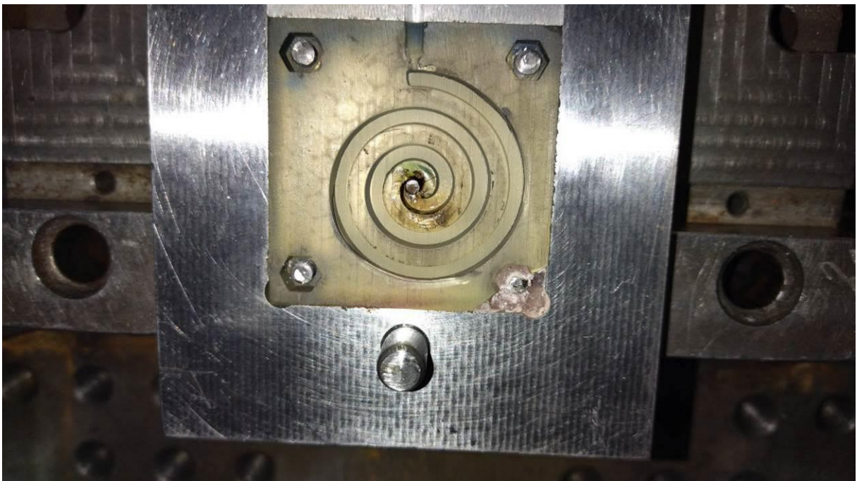
Slika 64. Izgled polimernog kalupa nakon četrdesetog otpreska (pomični alat)
