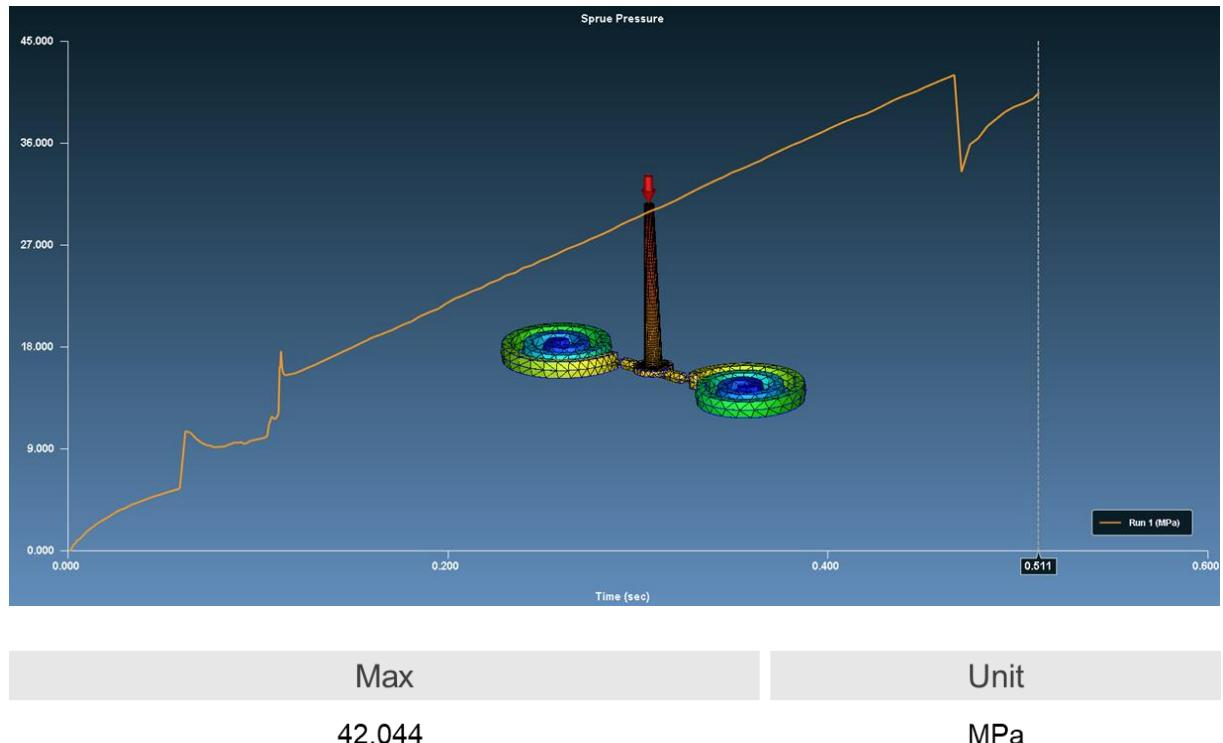
**Slika 23. Tlak uljevka kod ubrizgavanja taljevine polimernog materijala**
