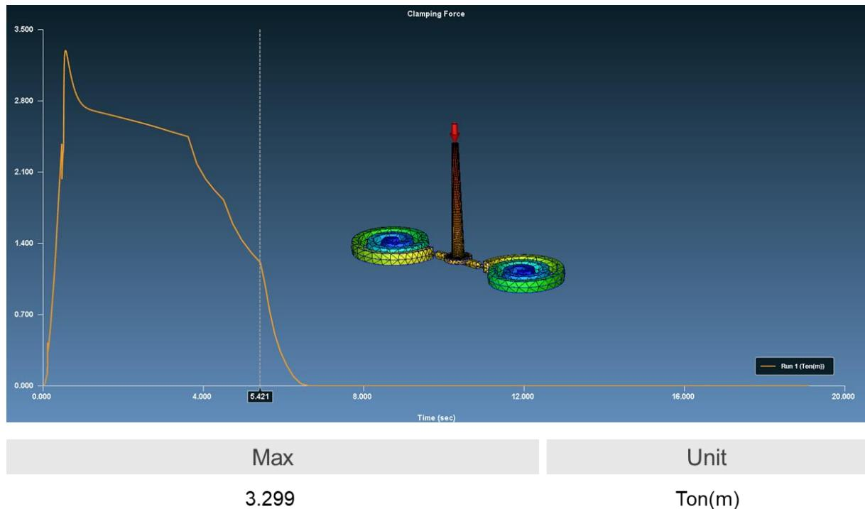
Slika 32. Sila zatvaranja kalupa kod faze naknadnog tlaka
