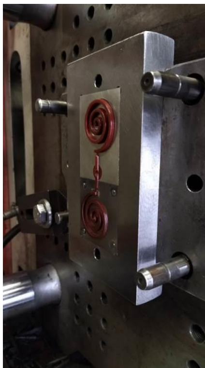
Slika 54. Izgled otpreska u kalupu za drugi pokušaj injekcijskog prešanja
