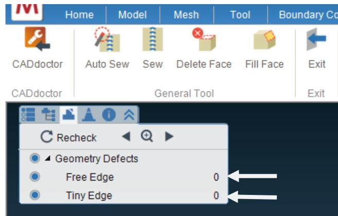
Slika 13. Naredba "Check geometry" za provjeru nepravilnosti modela
