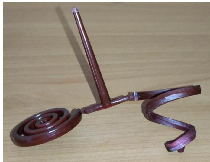
**Slika 55. Primjer izvinutog otpreska iz polimernog kalupa**
