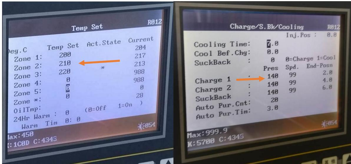
Slika 47. Parametri stroja za prvi slučaj injekcijskog prešanja
