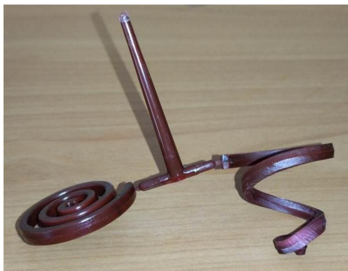
Slika 55. Primjer izvinutog otpreska iz polimernog kalupa
