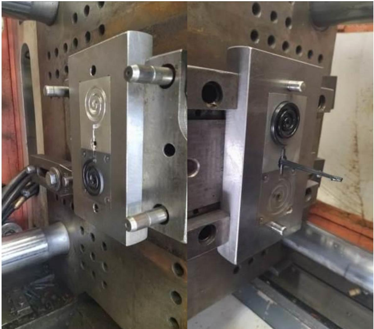
**Slika 57. Izgled kalupa nakon prvih deset otpresaka**
