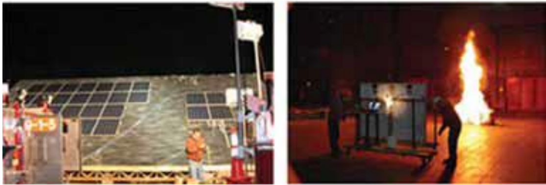
Slika 16. Osvjetljenje fotonaponskog panela reflektorima i plamenom [9]
