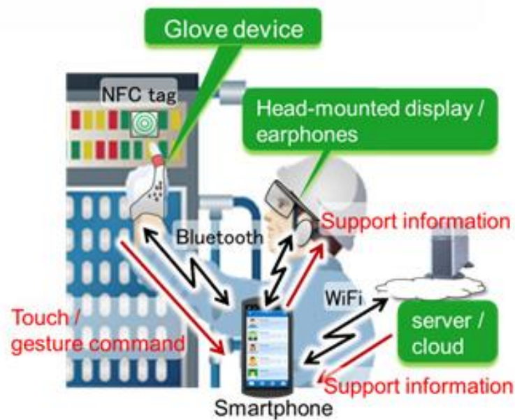
Slika 21. Komunikacija zaštitnih rukavica - od NFC čipa preko smartphona do samog radnika (putem slušalice) [11]
