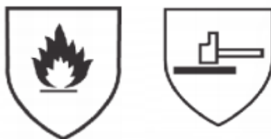
Slika 8. Prikaz piktograma za zavarivačke rukavice
