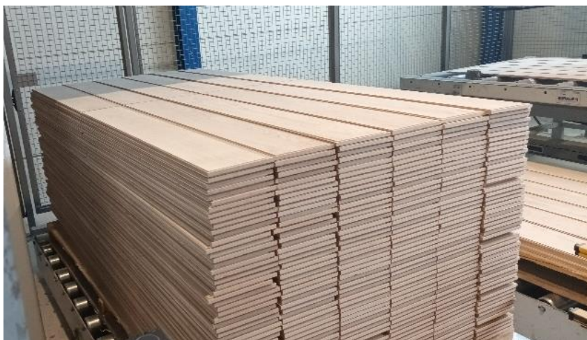
slika 4. nedovršeni paneli kratkog parketa na ulazu u portal lakirnice (izvor:osobna arhiva autora)
