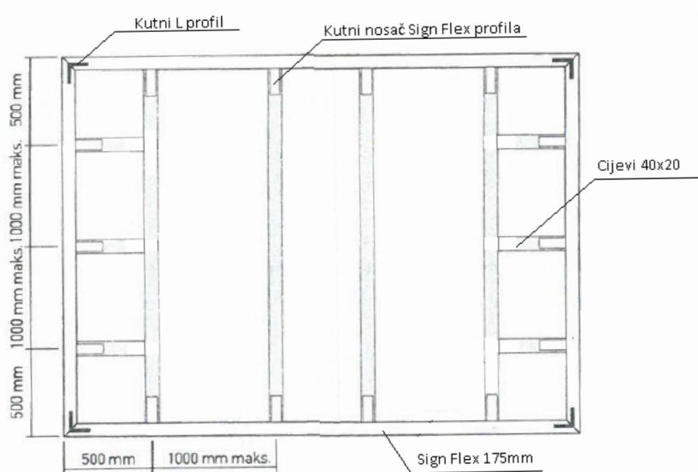
**Slika 32. Konstrukcija Sign Flex profila [11]**
