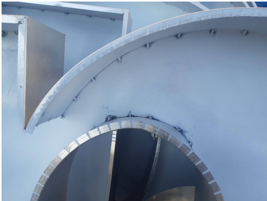
Slika 6. Prikaz savijanja bočne strane 3D slova
