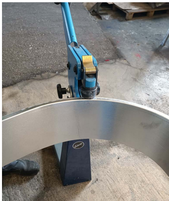
Slika 7. Savijačica za limove do 2mm debljine
