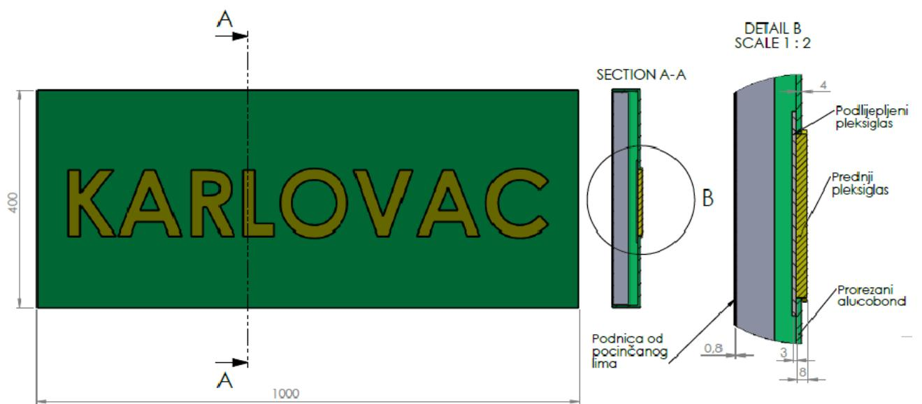
**Slika 25.** Prikaz dijelova svjetleće kutije
