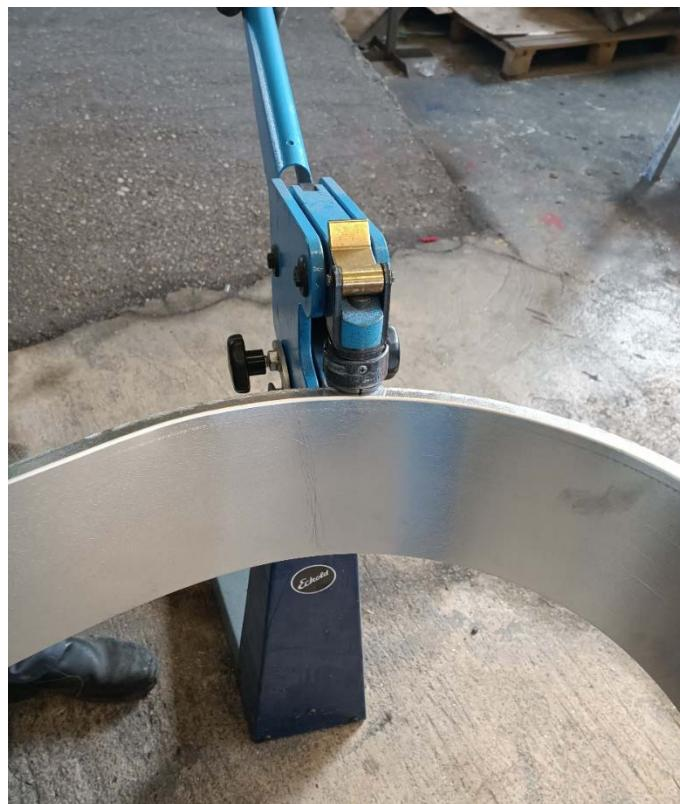
Slika 7. Savijačica za limove do 2mm debljine
