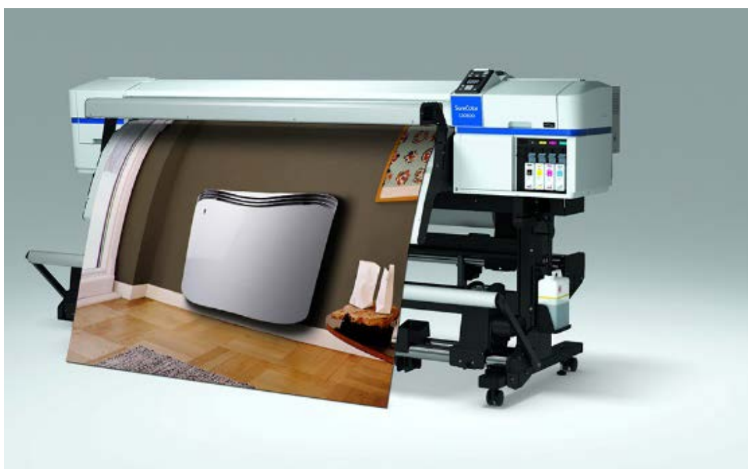
Slika 26. Pisač za digitalni tisak na ceradu [8]
