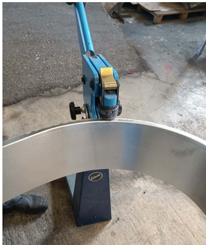
Slika 7. Savijačica za limove do 2mm debljine
