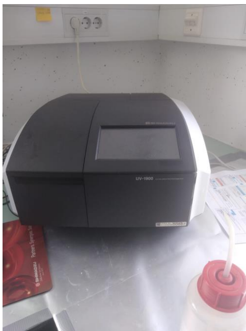
Slika 7. Uređaj za mjerenje absorbancije, SHIMADZU UV-1900
