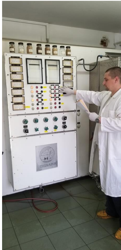
Slika 13. Ziemann uređaj za proizvodnju piva
