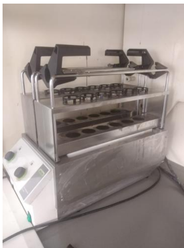
Slika 6. Uređaj za otparavanje Buchi
